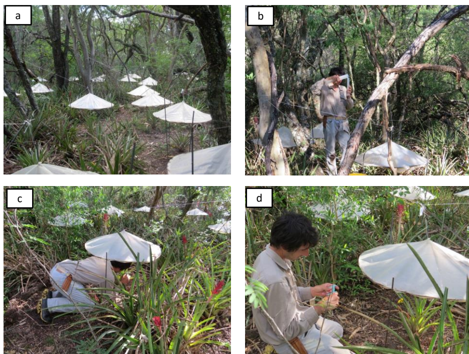
Figura 4.4. Detalle de las actividades realizadas a campo durante el experimento de riego. (a): vista de la disposición de las plantas en el sotobosque del quebrachal, (b) y (c): aplicación del agua establecida para cada planta de acuerdo con el protocolo de riego, (d): medición del nivel de agua del tanque.
