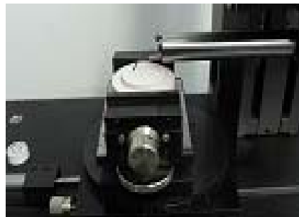
Figura 6. Rugosímetro de banco TSK SURFCOM 140
