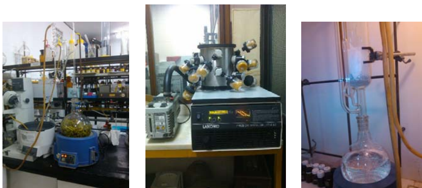
Figura 2. Equipos utilizados para la extracción vegetal. a) Clevenger para la extracción de aceites esenciales por arrastre con vapor de agua; b) Liofilizador de muestras acuosas; c) Soxhlet para obtención del extracto hexánico de R. communis .
