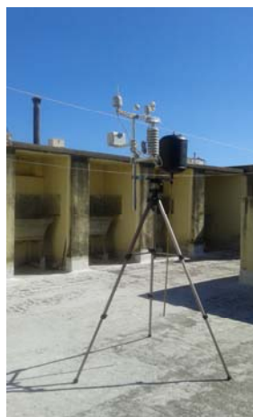
Figura 4: Estación meteorológica portátil con termómetro de globo.
