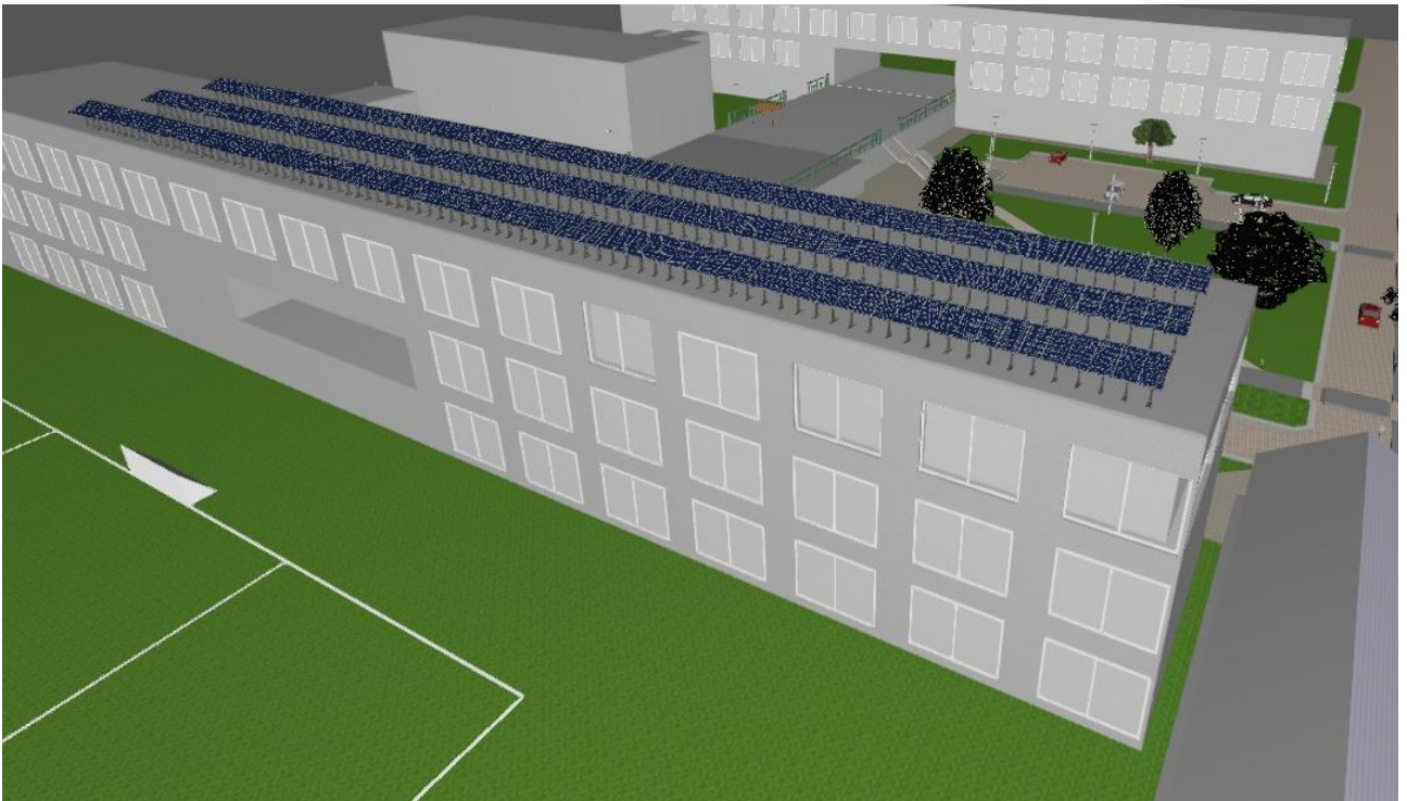
Figura. 6.10.13: Disposición de los paneles fotovoltaicos sobre el edificio de ciencias políticas.
