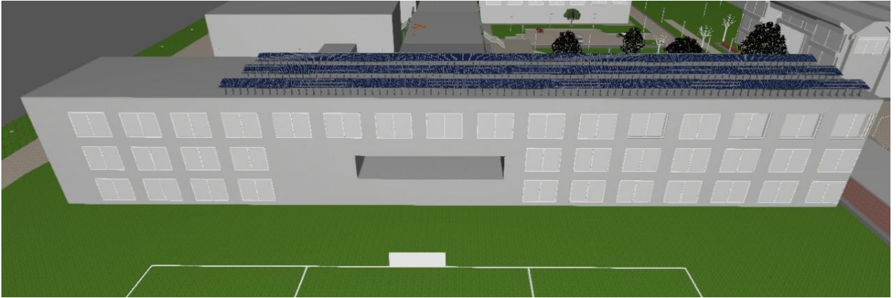
Figura. 6.10.12: Disposición de los paneles fotovoltaicos sobre el edificio de ciencias políticas.
