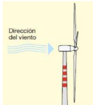
Figura. 5.9.2.2.1.2: Aerogenerador tipo Sotavento.
