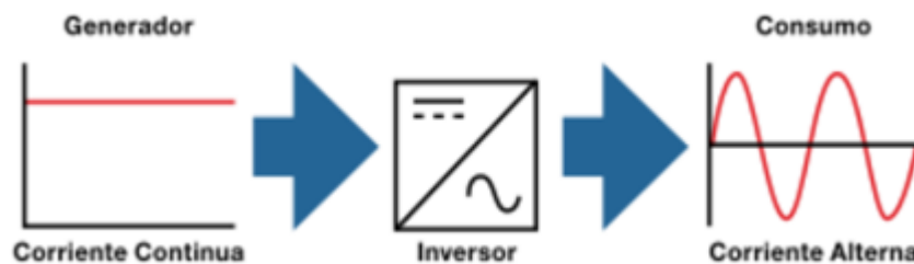
Figura. 5.9.1.2.1: Esquema de funcionamiento de un inversor.
