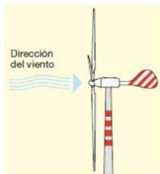
Figura. 5.9.2.2.1.1: Aerogenerador tipo Barlovento.
