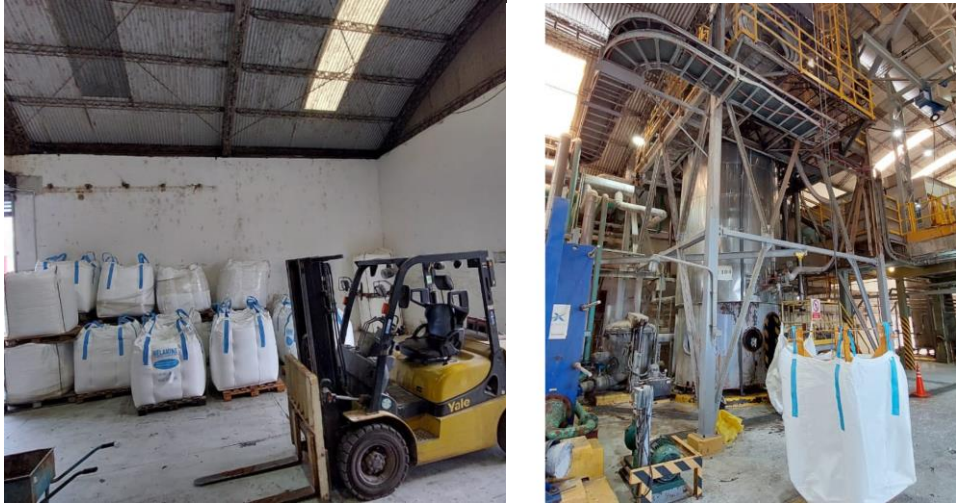
Figura 9. Izquierda: depósito de melamina. Derecha: traslado de melamina hacia el primer piso.
