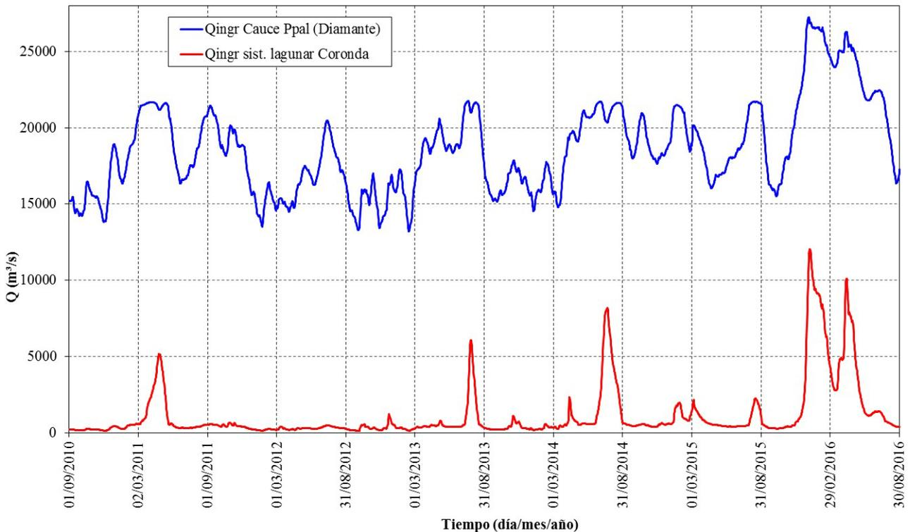
**Figura 2.-** Hidrogramas de ingreso de caudales en el cauce principal (Diamante) y en sistema Coronada
