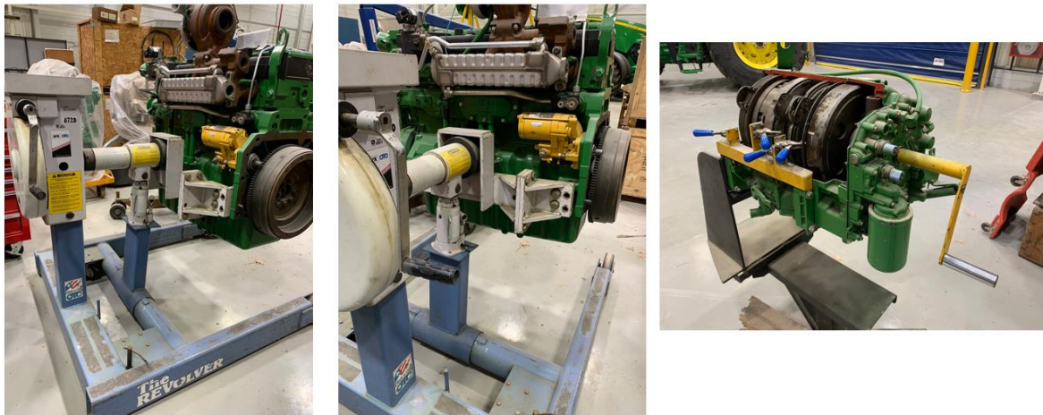
Imagen 41: Fotografías ilustrativas de diferentes dispositivos de rotación del motor
