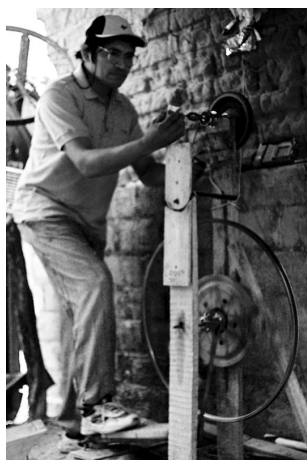
Figura 36. Gerardo Juárez lija un pajarito con el torno a pedal que él mismo se construyó, Morillo, 2006.
