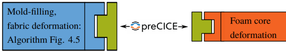
Figura 15: Esquema de acople FSI para modelar la fabricación de componentes RTM tipo sándwich por Seuffert. [61]
