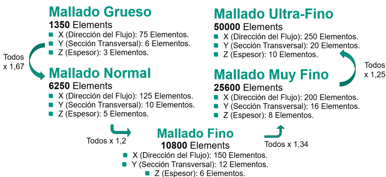
Figura 25: Plan de estudio de convergencia para el participante Sólido y distribución específica de elementos para cada malla.
