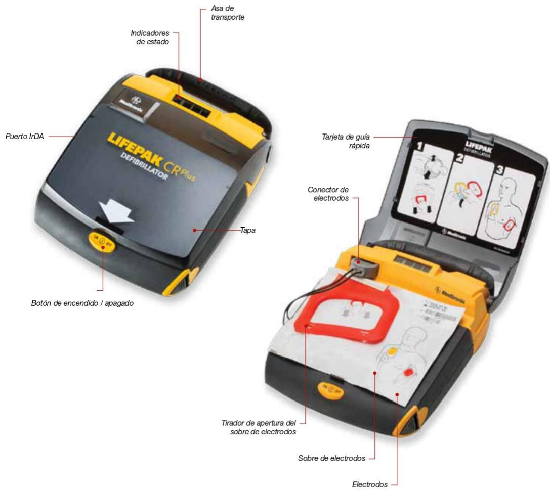
Figura 24. DEA abierto y cerrado con descripción de partes. Fuente: Folleto de la empresa Medtronic, compañía internacional de dispositivos médicos para su producto Desfibrilador Automático LIFEPAK CR Plus. Physio-Control (2011), p.16.
