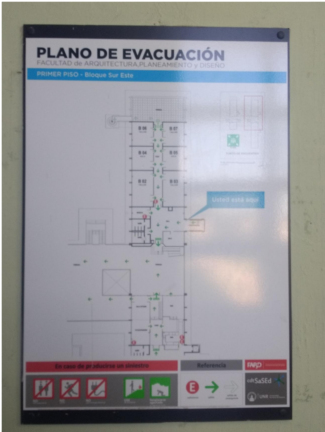
Figura 21. Fotografía cartel con plano de evacuación con indicaciones sobre salidas de emergencia en primer piso de la FAPyD. Fuente: elaboración propia.
