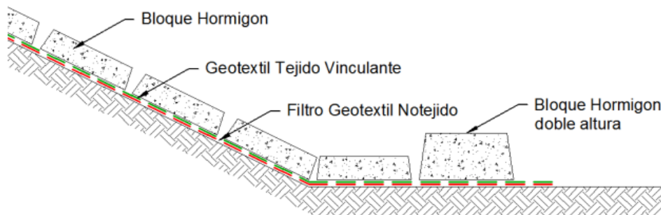
Ilustración 4.1-8 Bloque de hormigón de doble altura en la parte inferior.
