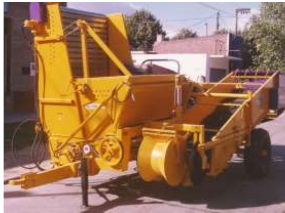
Figura 1-4: cosechadora recolectora marca Balthom de una hilera. Es traccionada por la barra de tiro y accionada por la toma de fuerza del tractor. Posee una mesa de inspección y embolsado, sumado a una plataforma hidráulica de descarga.
