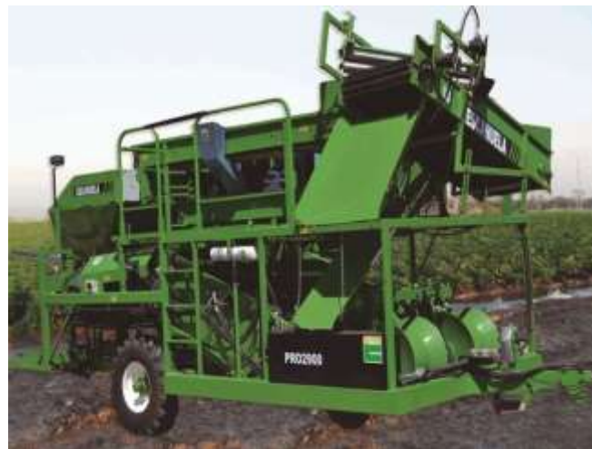
Figura 1-6: cosechadora recolectora Escañuela modelo PRO 2900. Cuenta con una configuración mas compacta que la CR290 pero con los mismos órganos. Se diferencia en su tolva trasera de almacenamiento.
