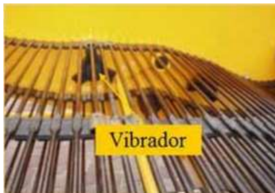
Figura 1-9: dispositivo de vibración de cinta de cribado. Este tipo de dispositivos cuentan con un rodillo lobulado que transmite un movimiento de vaivén vertical a la cinta, removiéndola y quitando las grandes porciones de tierra adheridas a las papas y reduciendo los terrones presentes
