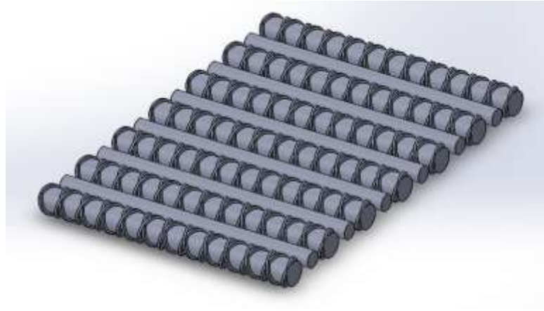
Figura 2-8: esquema básico de rodillos, conformado por siete rodillos principales y seis barras fijas intermedias.
