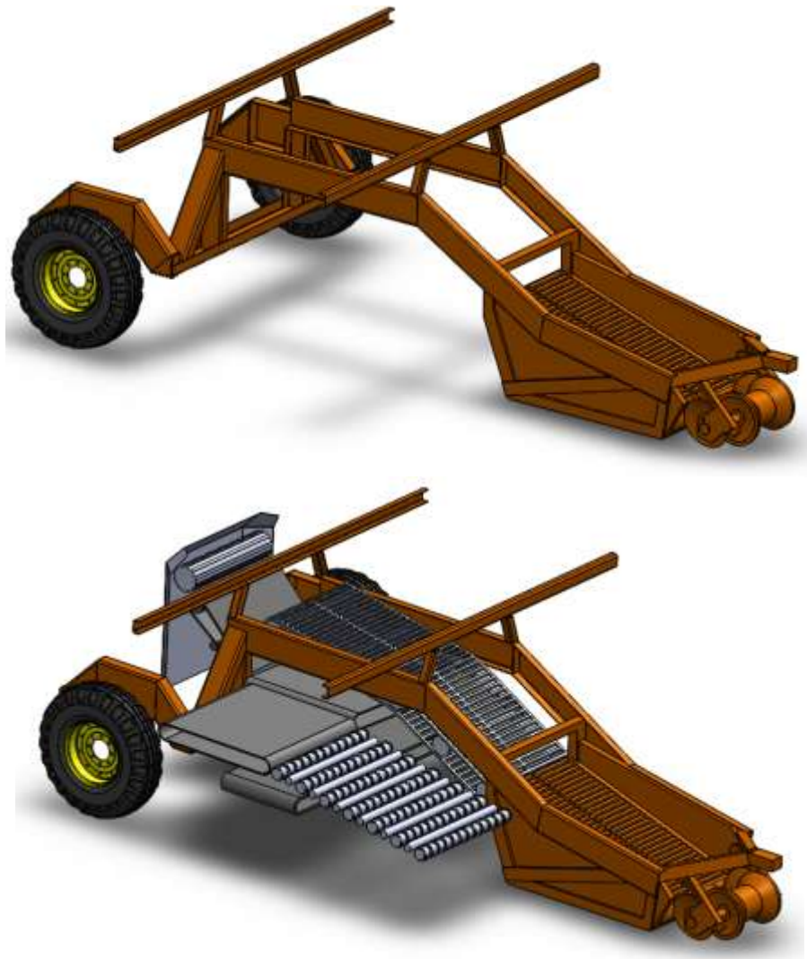
Figura 3-26: marco principal del chasis. Arriba: se puede observar más detenidamente la geometría principal. Abajo: conjunto posicionado de sistemas de cribado, desbroce, limpieza y cinta de desechos.
