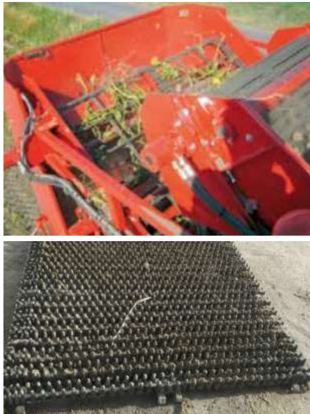
Figura 1-13: Métodos de separación del follaje. Arriba, cinta de cadenas. Abajo, cinta de dedos.
