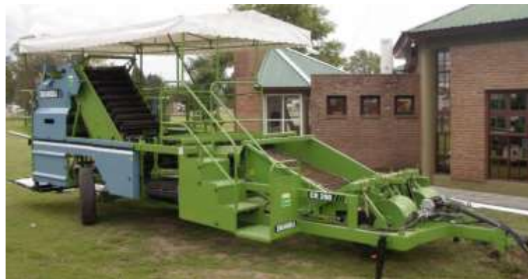
Figura 1-5: Cosechadora de arrastre modelo CR290 de la marca Escañuela. Posee dos líneas de cosecha, dirección hidráulica y mesa de clasificación. Almacena el material en bolsones de un metro cúbico.
