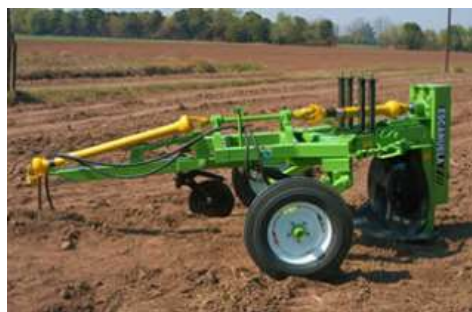
Figura 1-2: arrancadora de papas por disco. Esta versión mejorada cuenta con un sistema de zafe mediante muelles, que evita atascamientos. Fuente: Escañuela maquinaria
