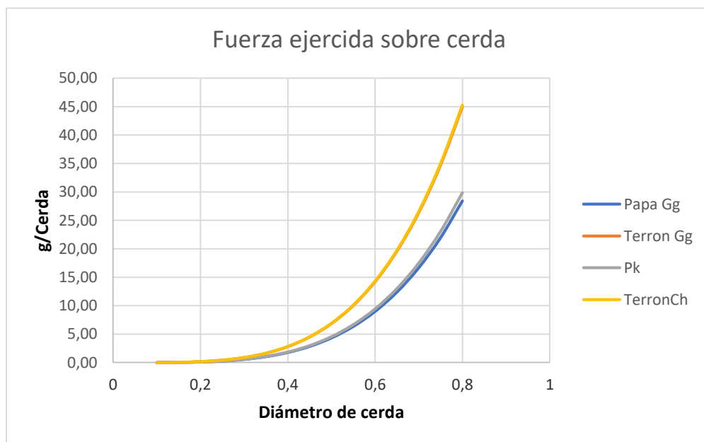
Figura 2-17: Gráfico de fuerza ejercida (en gramos) sobre cada cerda para los distintos diámetros propuestos. La serie "Pk" representa la carga crítica de la cerda, equivalente a la ejercida por la papa más pequeña.
