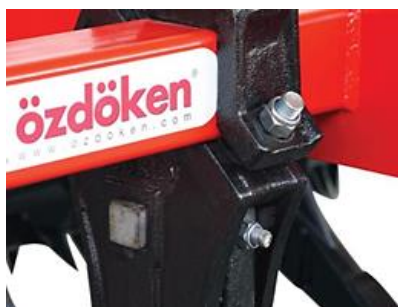
Figura 1-2: Amarre al bastidor que permite mover las herramientas de corte a lo ancho del mismo.
