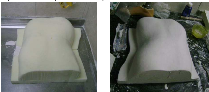
Fig. 3-... – Izquierda: bloques unidos al final del mecanizado, Derecha: bloques sellados con resina
