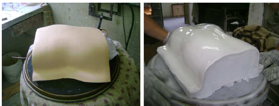
Fig. 3-... – Izquierda: conformado con EVA, Derecha: conformado con PP
