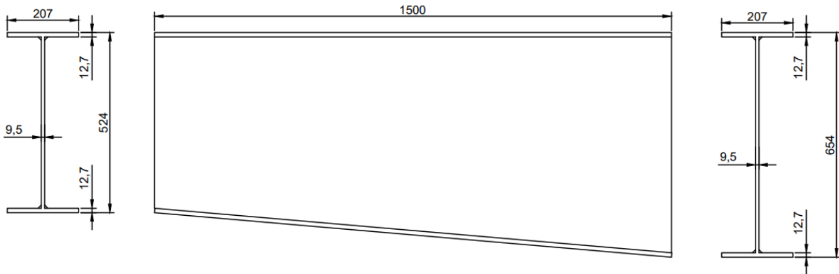
Figura 69. Rigidización de nudo superior de viga de cubierta. Fuente: Elaboración propia.
