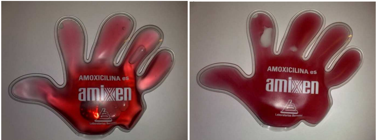
Figura 3.1: (Izquierda) Almohadilla de calentamiento en estado metaestable.
