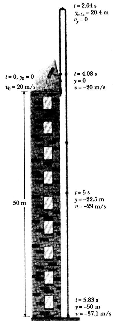
$$a) \quad t = \frac{v - v_0}{-g} \Rightarrow t = \frac{0 - 20 \frac{m}{s}}{-9,8 \frac{m}{s^2}} \Rightarrow t = 2,04s$$
