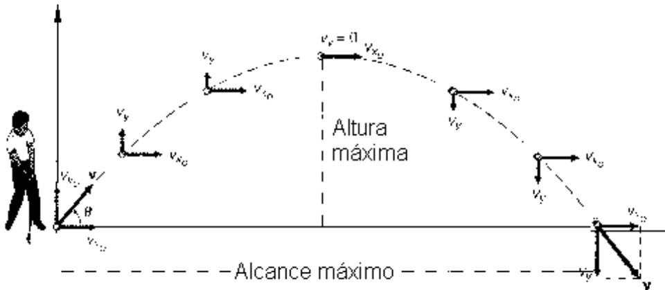
El vector velocidad es tangente a la trayectoria en cada punto (velocidad variable) y el vector aceleración es siempre vertical, dirigido hacia abajo y de módulo constante.
