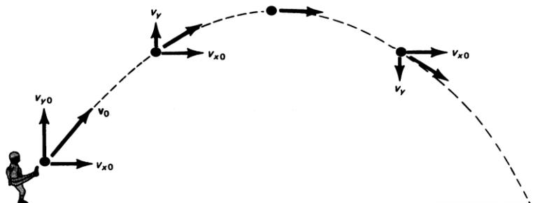
En la Figura se observa que la componente vertical  $\vec{v}_y$  de la velocidad varía mientras que la componente horizontal  $\vec{v}_x$  permanece constante.
