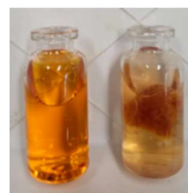
Figura2. Testigo inicial (izq) y estado final de una solución de naranja de metilo en contacto con la esponja s/absorbente durante 1 hora.
