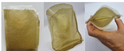
Figura 1. Fotografía de las bolsas biodegradables con matrices compuestas de gelatina y PYM10%
