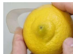
Figura 1. Película de pectina cítrica con aditivos obtenidas mediante el método de casting.
