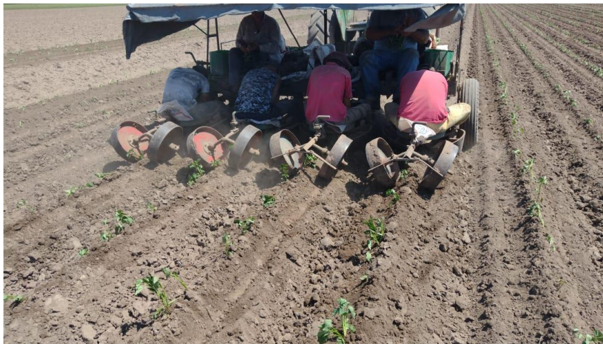
Ilustración 7: Trasplantadora convencional de 4 surcos
