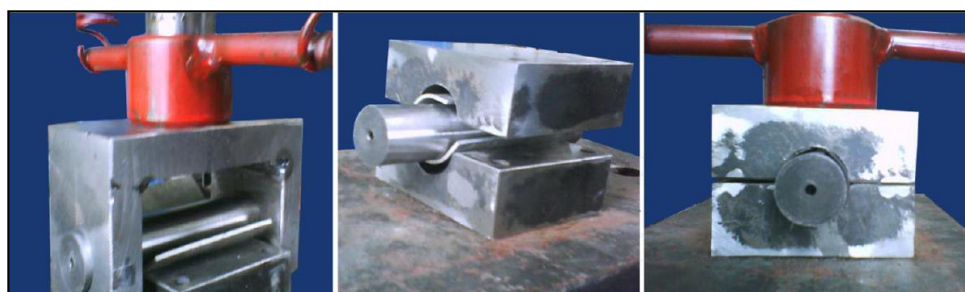
FIG.I.21 Diferentes etapas en el proceso de plegado de la chapa Fe-15Mn-5Si-9Cr-5Ni para la construcción del prototipo de acople con memoria de forma soldado [D14].
