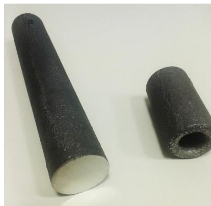
FIG.II.4 Aspecto de las barras fundidas, de diámetro 34 mm, y sección de corte transversal, mostrando buen llenado, el rechupe se localizó en la zona superior.
