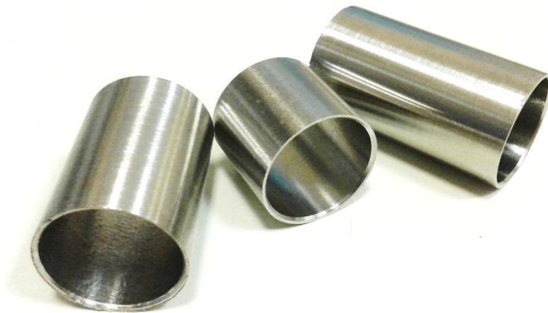
FIG.IV.29. Acoples terminados, fabricados por el método de punzonado-extrusión y luego del maquinado final de dimensionamiento.
