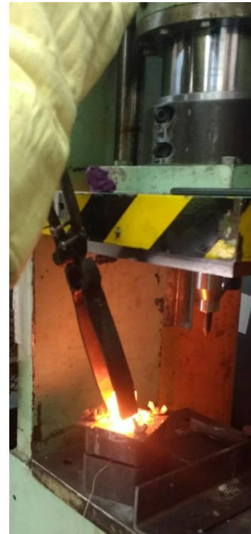
FIG.IV.14 Introducción del bloque caliente en la matriz.
