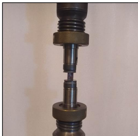
FIG.II.7 Muestra prismática entre los cabezales planos de compresión de la máquina Instron 3382.
