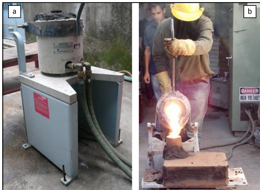
FIG.II.2 a) Horno de inducción volcador y respectivas mangueras de alimentación/refrigeración. b) Momento de la colada de la aleación dentro del molde de arena. Por detrás se puede observar el generador de potencia.
