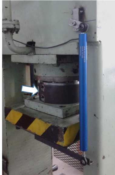
FIG.A1.2 Sensor de desplazamiento LDI 119 montado sobre la prensa y acoplado al cabezal móvil; y collar para reducción de carrera disponible (flecha blanca). Se muestra la posición de mínima carrera (o sea cilindro cerrado).
