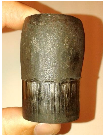
FIG.IV.15 Preforma defectuosa por problema de introducción en la matriz. Se diferencian las zonas de deslizamiento forzado, y la de aplastamiento.
