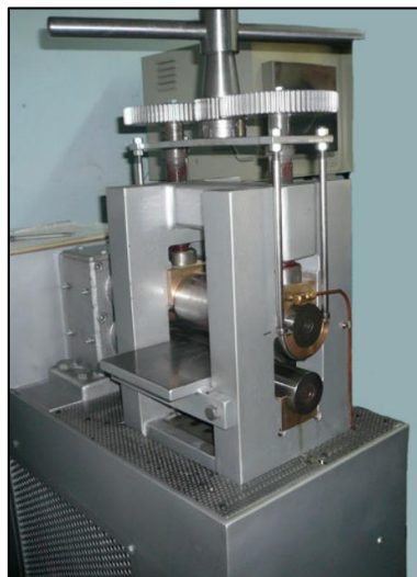
FIG.II.5. Laminadora de 4HP disponible en el taller del IFIR. La separación entre los rodillos se regula mediante la manivela superior, a fin de ajustar el grado de reducción. Más atrás se observa el horno mufla.
