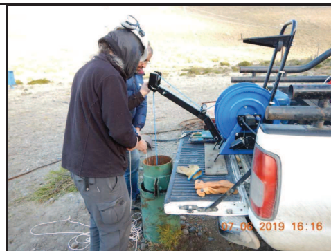
Imagen 5.11. Tareas de descenso de cámara durante la videoinspección.
