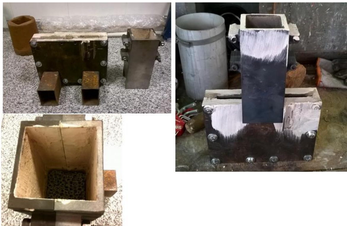
Figura 3.3: Fotos de la lingotera metálica con su respectivo embudo. Su interior está pintado, listo para realizar la colada.
