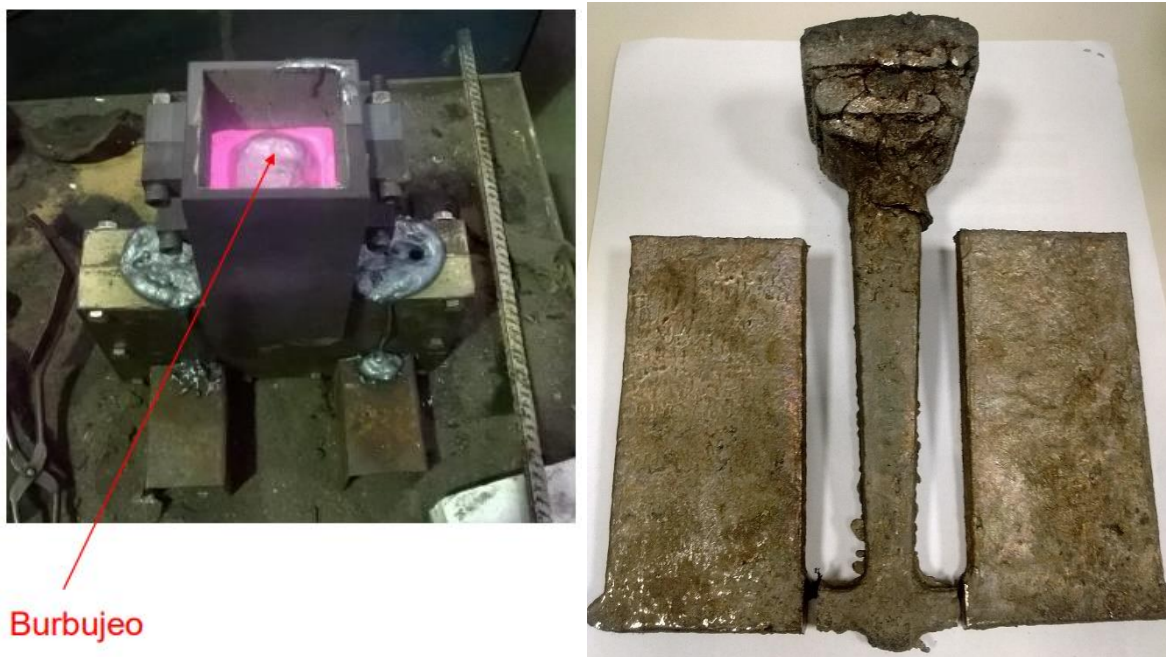
Figura 3.4: a) Material colado, se observó un burbujeo típico de las coladas metálicas. b) Lingotes obtenidos de acero Fe-22Mn-0.6C-1.5Al. Entre los lingotes se observa el material solidificado en el canal de colada y el embudo.
