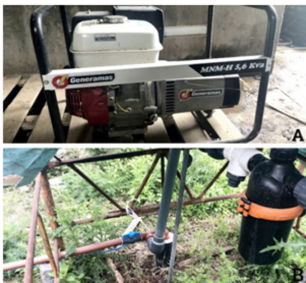
Figura 2: A) generador a gasolina; B) Bomba de agua para irrigación. Fuente: Autoría propia
