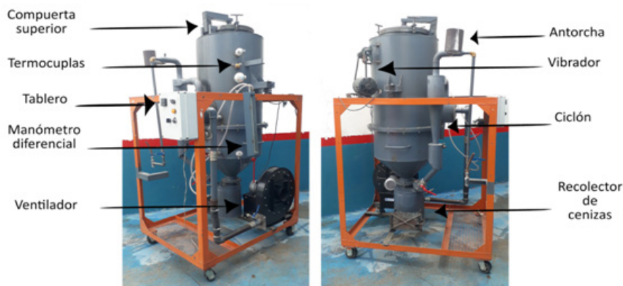
Figura 3: Foto del gasificador desarrollado y construido por nuestro equipo de investigación y desarrollo, indicando algunas de sus partes constructivas.
