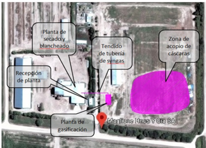
Figura 6: Planta Maglione Hnos y Cia S.A. con ubicación de planta gasificadora y tuberías.
