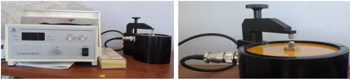
Figura 2.17. Piezómetro comercial usado para medir el coeficiente piezoeléctrico d_{33} .
