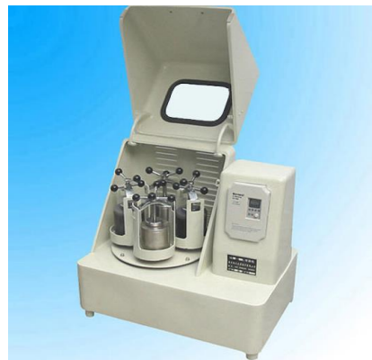
Figura 2.3. Jarras y bolas de circona y molino Planetario.
