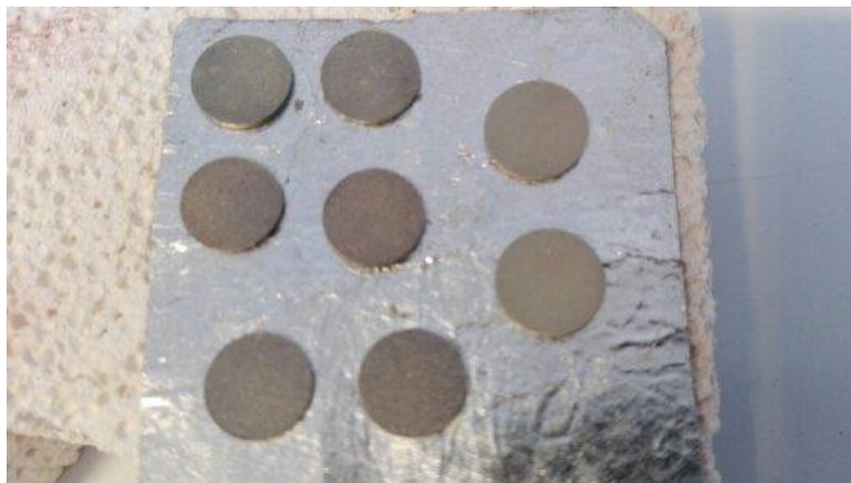
Figura 2.9. Pastillas sinterizadas a temperaturas del orden de 1400^{\circ}\text{C} .
