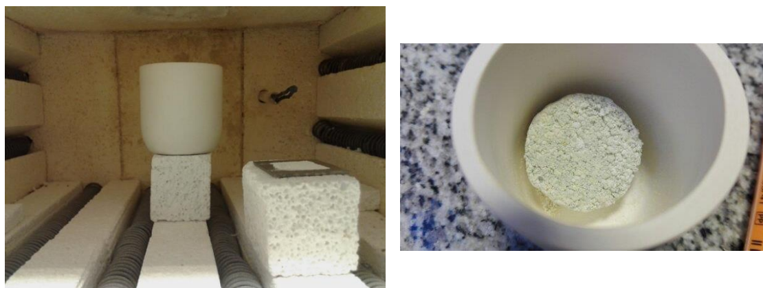
Figura 2.5. Calcinación de polvos. Crisol de ZrO 2 .
