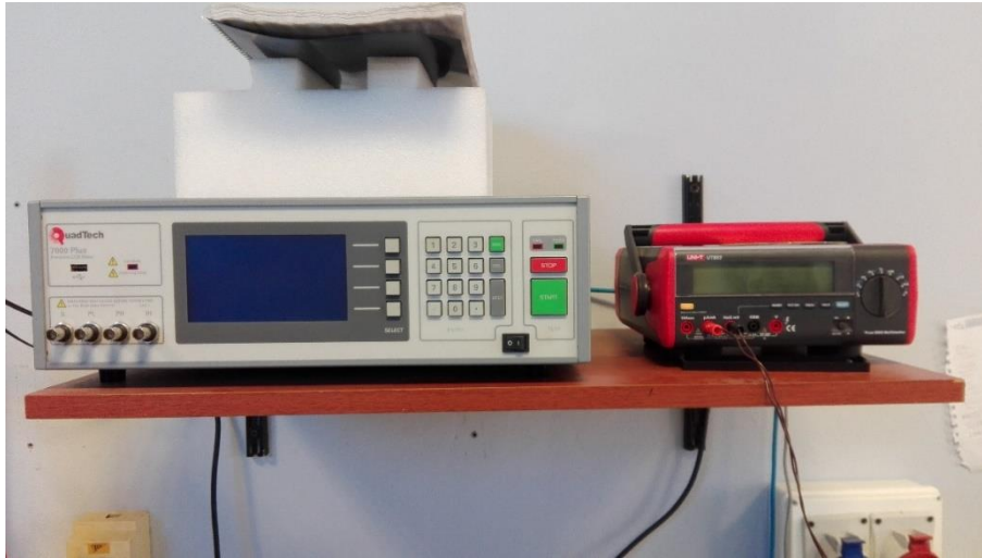
Figura 2.14 a. Vista general del equipo utilizado para mediciones dieléctricas. Impedancímetro Quadtech y multímetro Uni -T usado como termómetro digital junto con termocupla K.
