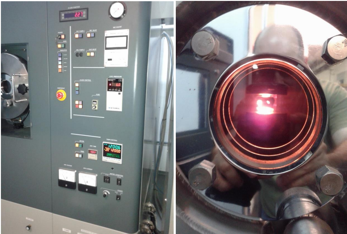
Figura 2.12. Vista parcial del equipo de Spark Plasma Sintering (izquierda) y vista de la cámara de sinterizado en funcionamiento (derecha).
