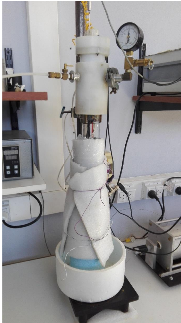
Figura 2.15. Crióstato casero que trabaja con N_2 líquido y trabaja entre -120^\circ C y 180^\circ C .
