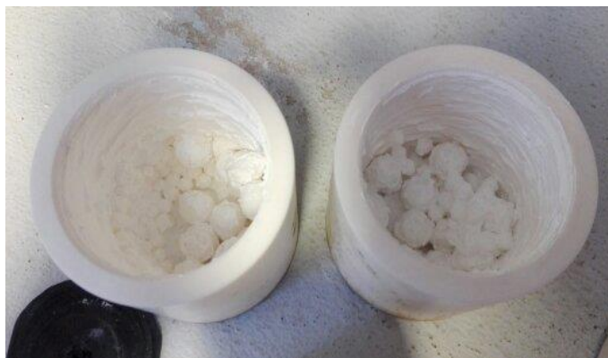
Figura 2.3. Jarras y bolas de circona y molino Planetario.
