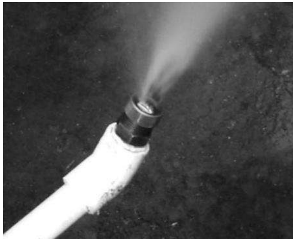
Figura 4-14: Formación de gotas mediante energía de presión hidráulica. (Castillo Herran, 2010)
