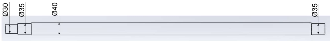
Figura 5-16: Resumen de diámetros seleccionados para el eje del mezclador.
