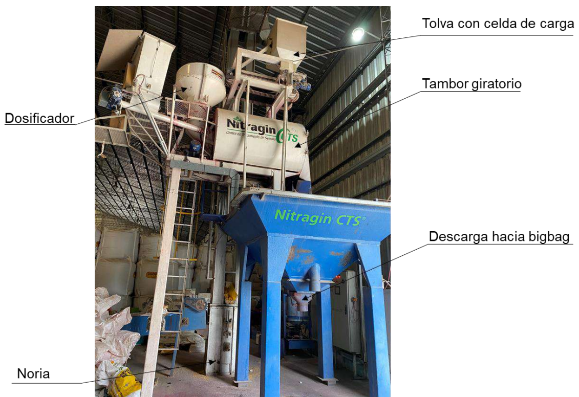
Figura 1-7: Componentes de la máquina para tratamiento profesional.
