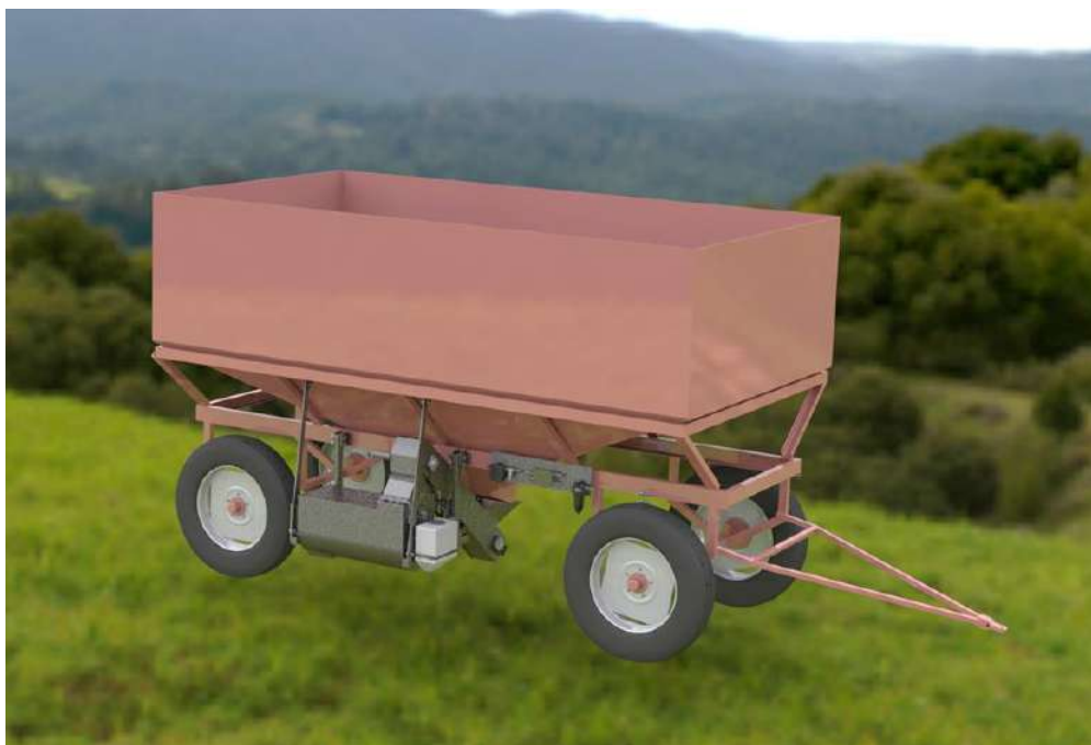
Figura 6-1: Render de equipo para tratamiento de semillas montado en tolva semillera.
