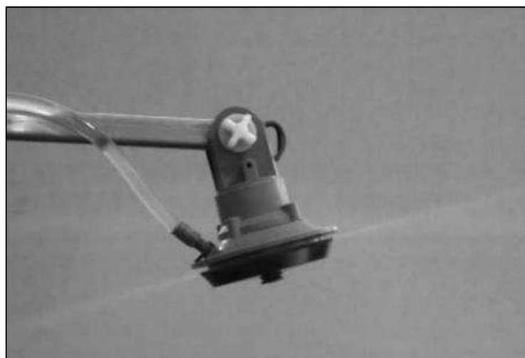
Figura 4-16: Formación de gotas a partir de energía centrífuga. (Castillo Herran, 2010)
