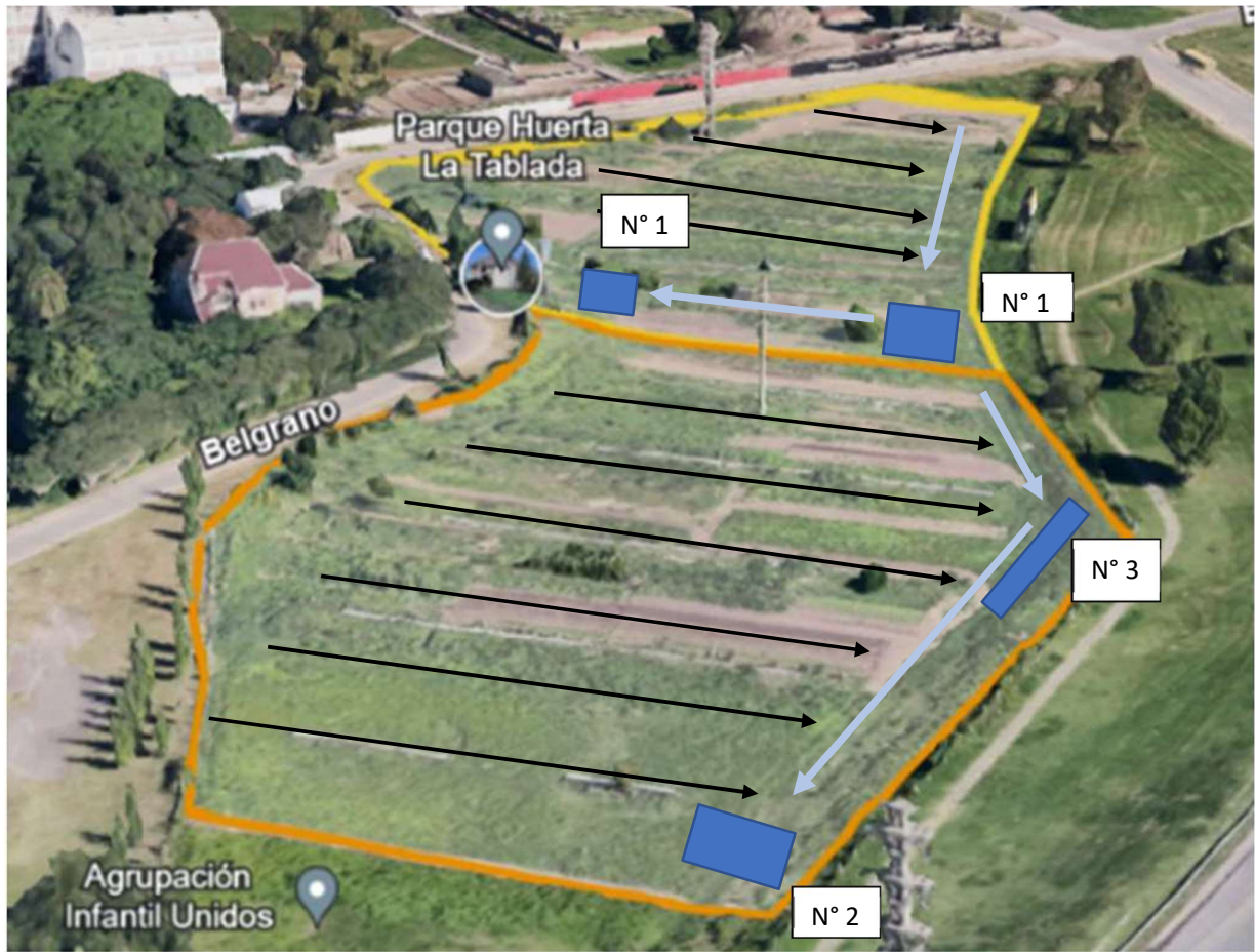
Figura 52 Disposición de escurrimientos superficiales hacia depósitos subterráneos
