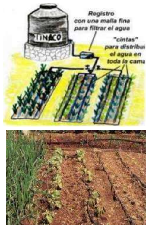
Figura 23. Cañerías de riego por goteo
