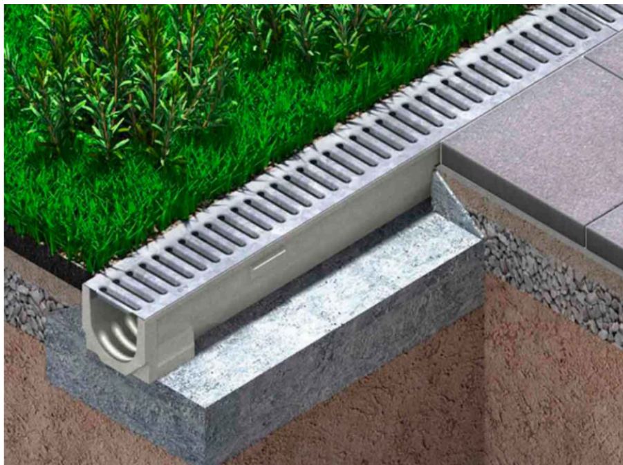
Figura 60. Ejemplo de canaleta de piso con rejilla
