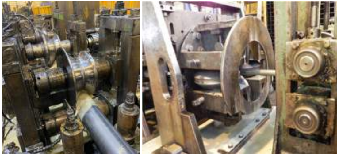
Figura 2-11 y Figura 2-12 : Se observan los pasos de preforma en la figura 2-11 de la izquierda y una cabeza de turco trabajando sobre un tubo de sección redonda en la Figura 2-12.
