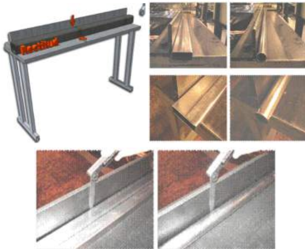
Figura 4-54: Imágenes del proceso de medición de rectitud actual.
