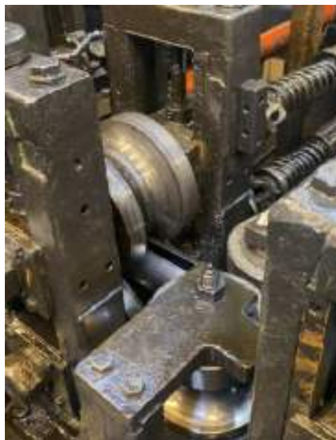
Figura 2-5: Imagen de los pasos de aleta o “fin pass”.
