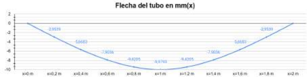
Figura 3-5: Curvatura del tubo al aplicar la fuerza P en el tubo redondo de diámetro d=127 mm y espesor e=3,2 mm, valor de “y” en mm.
