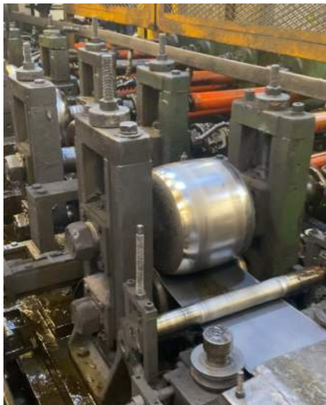
Figura 2-3: Imagen de los primeros pasos de conformado y las guías de entrada.
