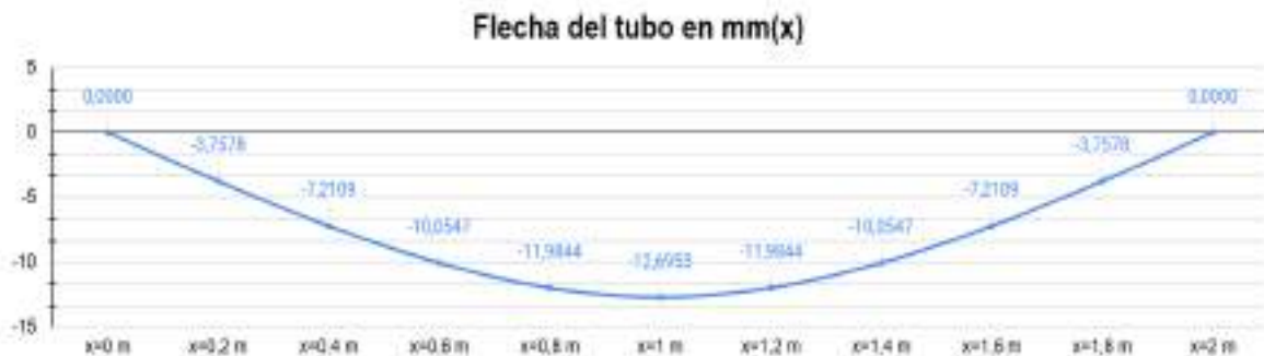
Figura 3-1: Curvatura del tubo al aplicar la fuerza P en el tubo cuadrado de 100 mm x 100 mm y espesor=3,2 mm, valor de “y” en mm.
