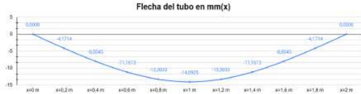
Figura 3-2: Curvatura del tubo al aplicar la fuerza P en el tubo cuadrado de 90 mm x 90 mm y espesor=4 mm, valor de “ y ” en mm.
