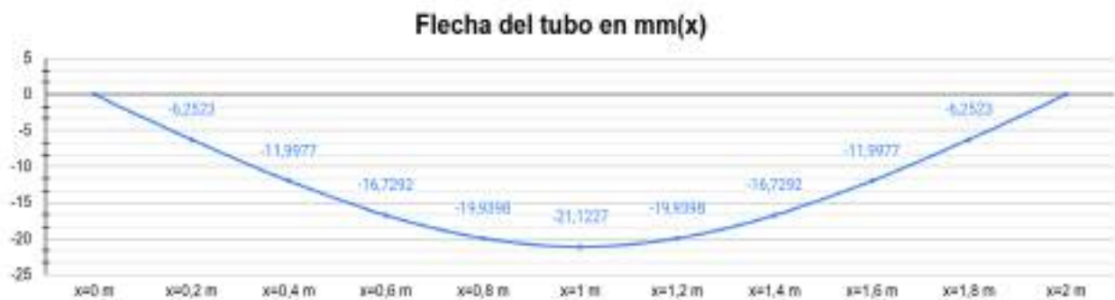
Figura 3-4: Curvatura del tubo al aplicar la fuerza P en el tubo rectangular de 60 mm x 120 mm y espesor=4 mm, valor de “y” en mm.
