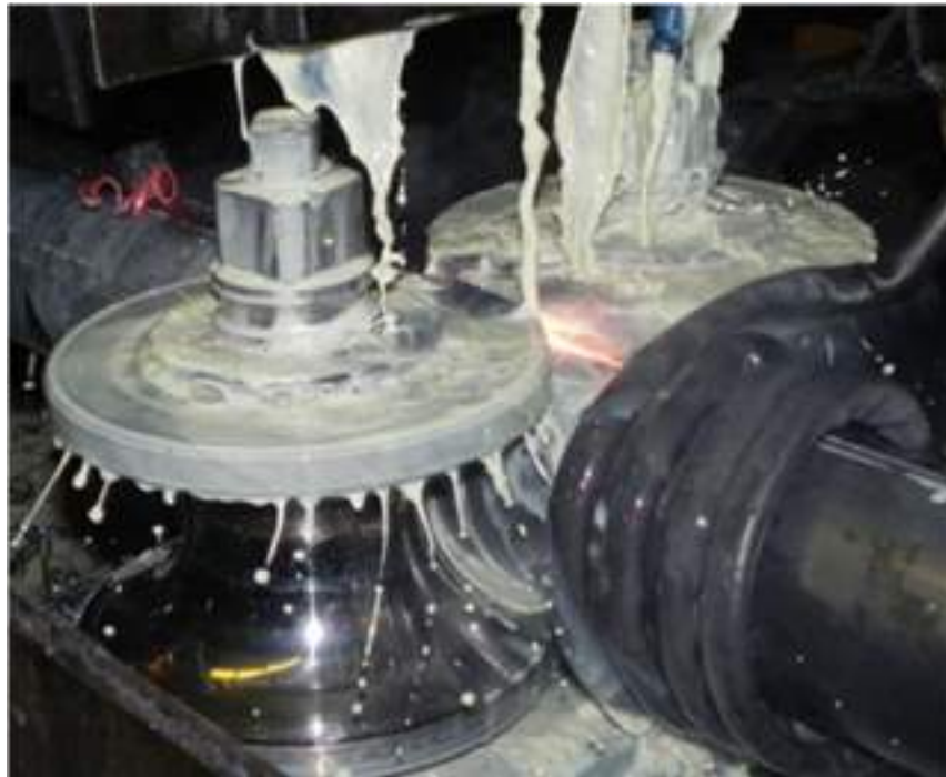
Figura 2-6: Soldadora continua del tipo “ERW”(Electric Resistive Welding):
