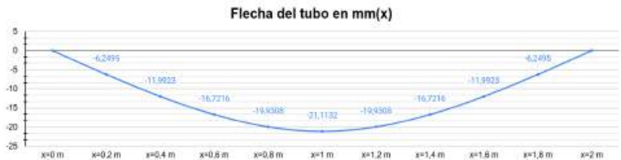
Figura 3-3: Curvatura del tubo al aplicar la fuerza P en el tubo rectangular de 60 mm x 140 mm y espesor=3,2 mm, valor de “y” en mm.
