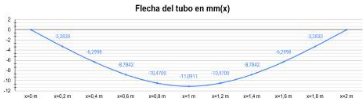
Figura 3-6: Curvatura del tubo al aplicar la fuerza P en el tubo redondo de diámetro d=114,3 mm y espesor e=4 mm, valor de “y” en mm.
