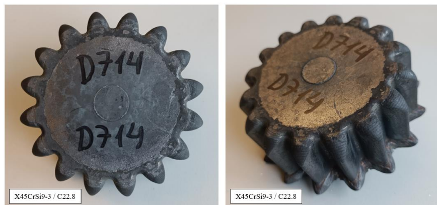
Figura 4.9: Engranaje recto híbrido D714 luego del conformado y el tratamiento térmico.
