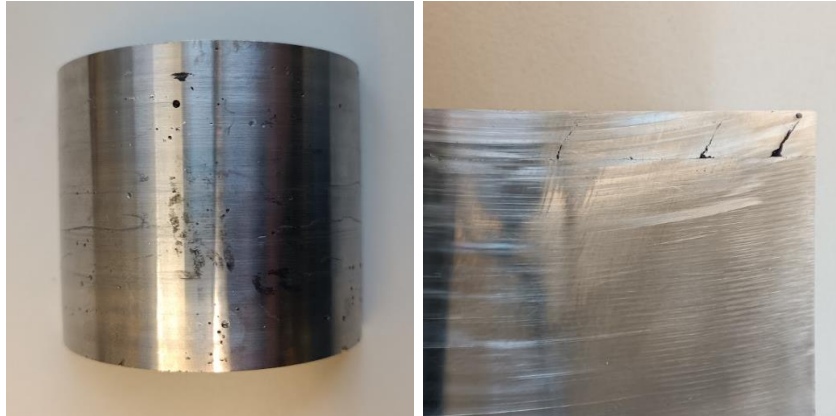
Figura 4.23: Fracturas y cavidades observadas en el producto semi-acabado de la combinación 100Cr6/C22.8
