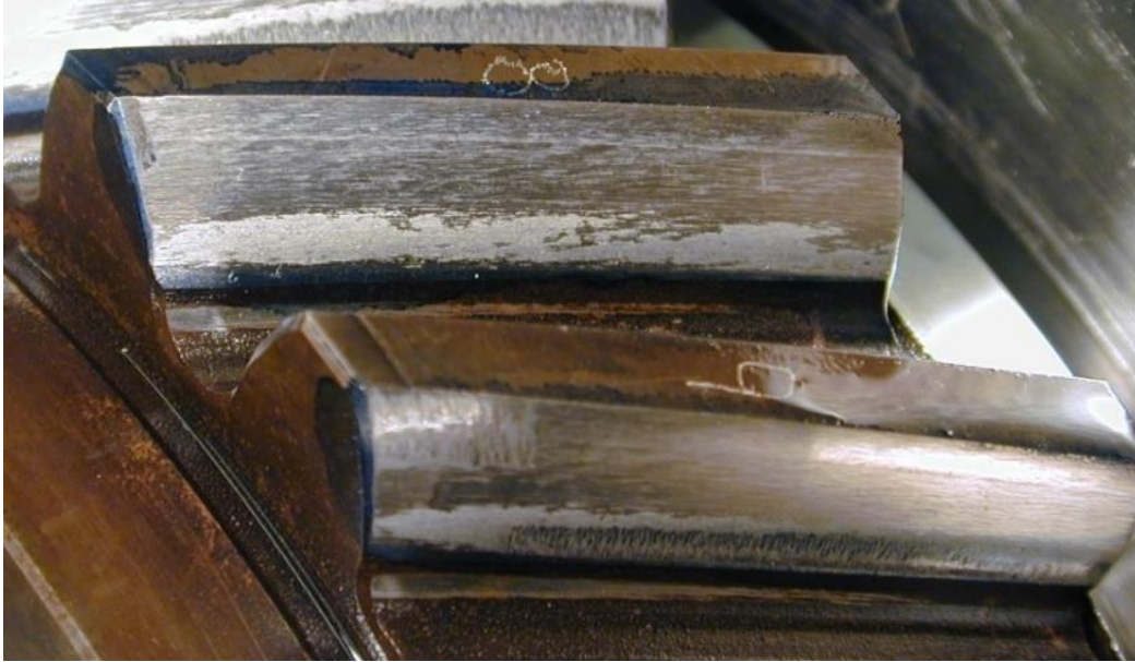
Figura 2.18: Daño por micropitting en el diente de un engranaje [19]
