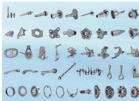
Figura 2.3: Ejemplos de la diversidad de formas posibles en piezas forjadas [14]
