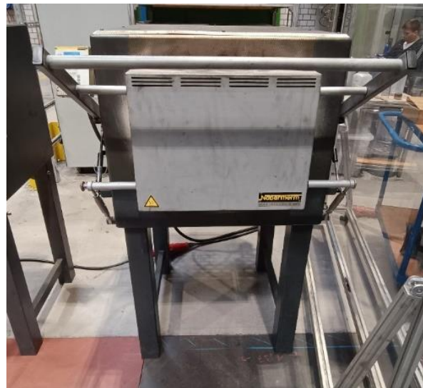
Figura 4.4: Horno de cámara usado para calentar las materias primas
