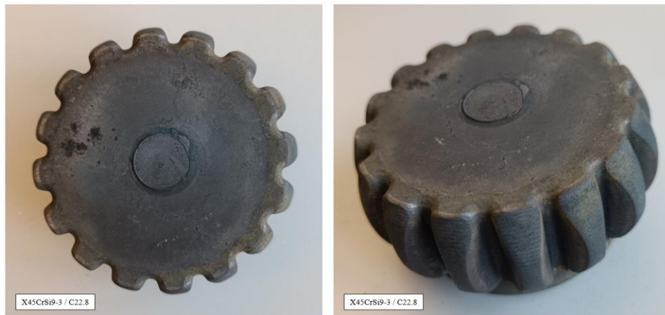
Figura 4.15: Engranaje recto híbrido D706 conformado incorrectamente
