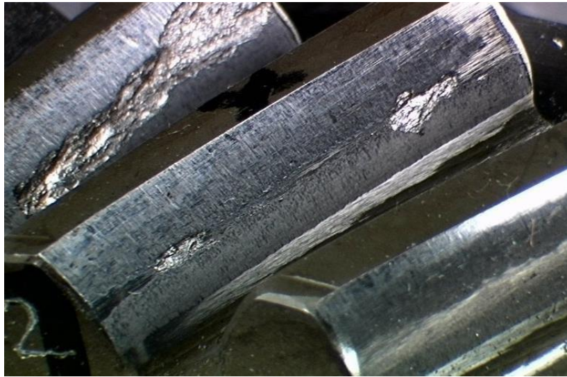
Figura 2.17: Daño provocado por pitting en el diente de un engranaje [19]
