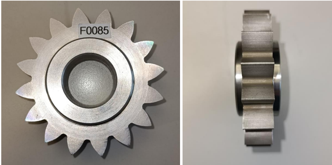
Figura 4.17: Geometría final del engranaje recto luego del proceso de Electroerosión por Hilo (EDM)
