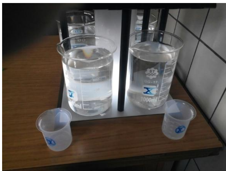
Figura 14.- Jarras junto a vasos de precipitado con la cantidad de ácido y sulfato a dosar.
