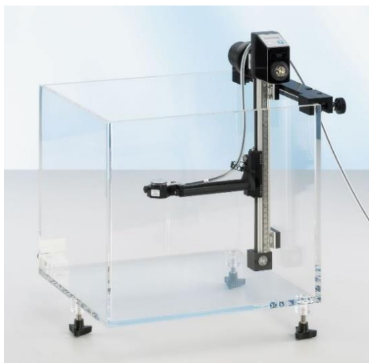
Figura 1.7: Fantoma de agua con cámara de ionización en su interior para medición de dosis en profundidad.
