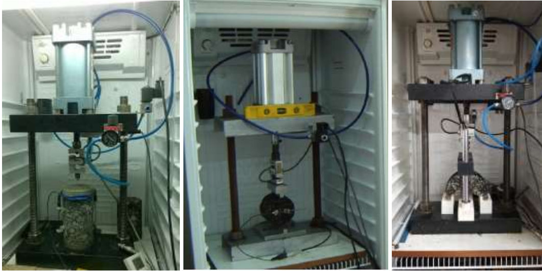
Figura 4-4. Equipo de ensayo para las tres modalidades presentadas (a) CU, (b) TI, (c) SCB.
