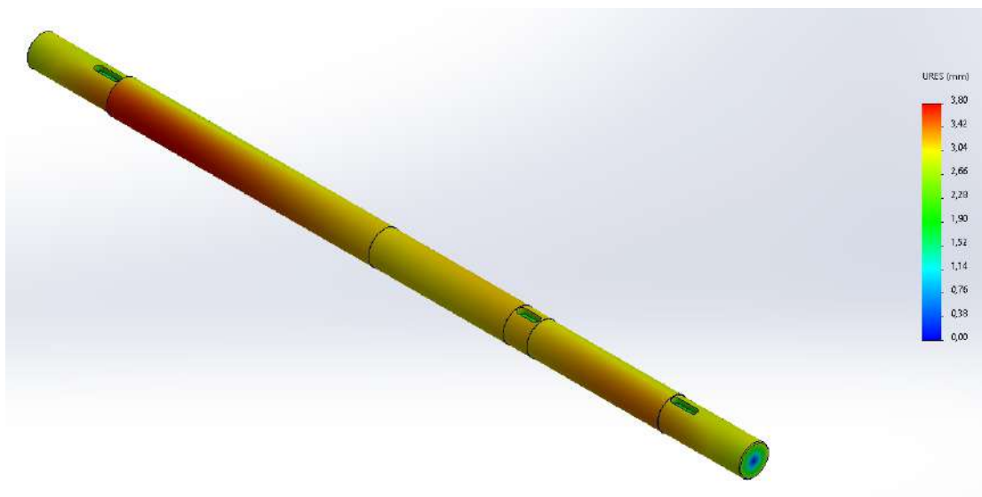
Figura 35: Deformaciones en el eje
