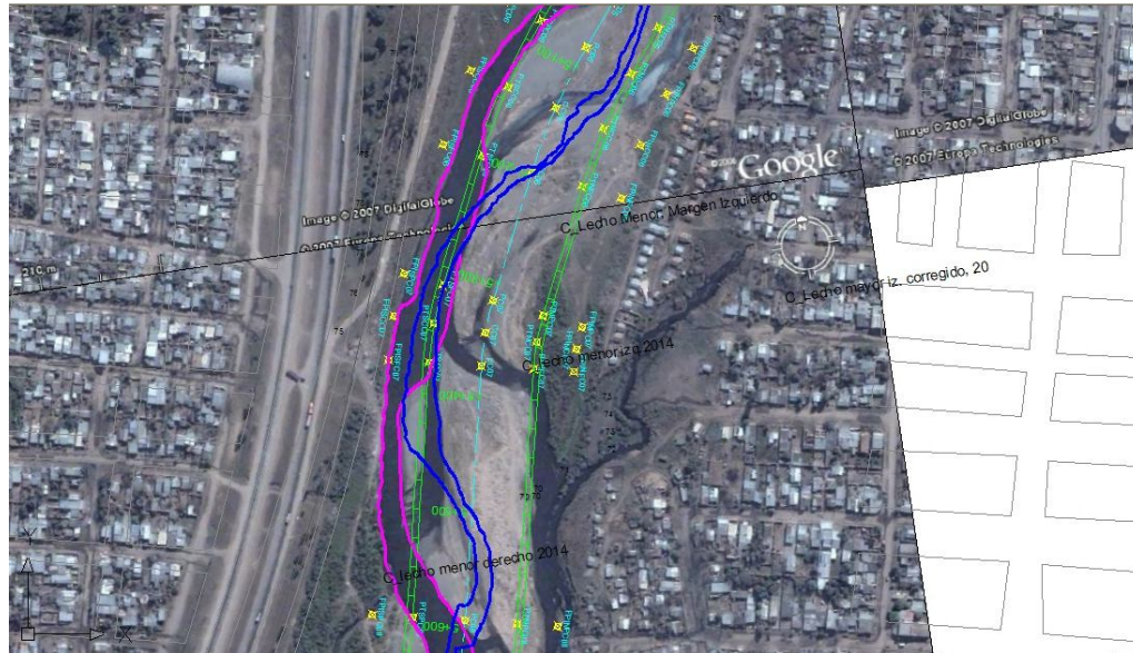
En la figura N° 7.25, Imagen satelital, definición del canal de estiaje, en los años 2002, 2014 y además se presenta el proyecto, tramo N° 07.-
