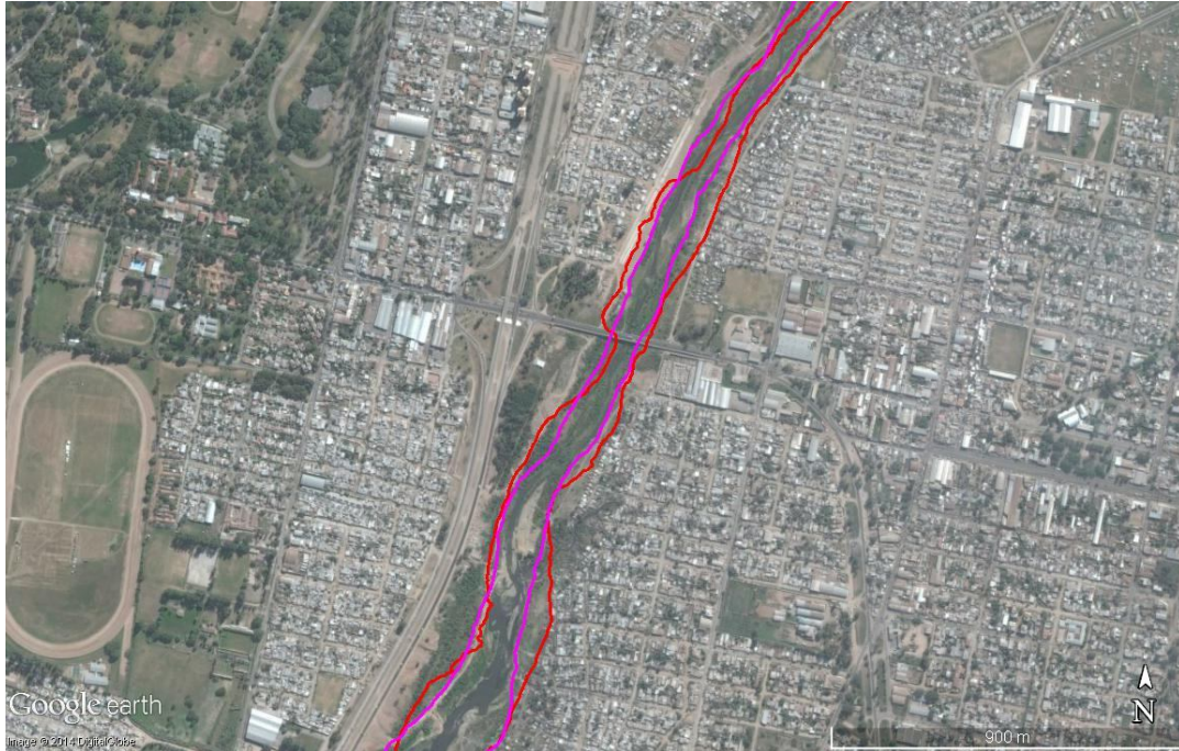
En la figura N° 7.16, Imagen satelital, definición del cauce menor, en los años 2.002 y 2.014, tramo 02.-
