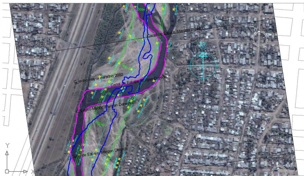
En la figura N° 7.26, Imagen satelital, definición del canal de estiaje, en los años 2002, 2014 y además se presenta el proyecto, tramo N° 08.-
