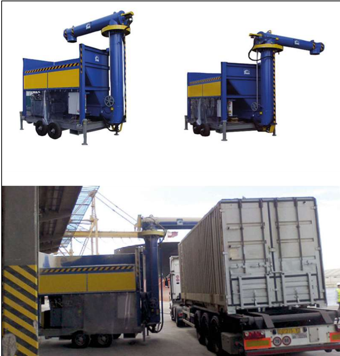
Imagen 21: Ejemplo tolva de carga con dosificador. Fuente: web es.zanin-italia.com.
