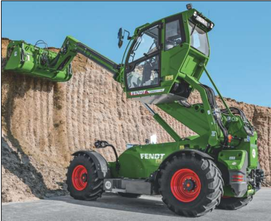
Imagen 23: Ejemplo pala cargadora híbrida con brazo telescópico y balanza incorporada. Fuente: www.fendt.com
