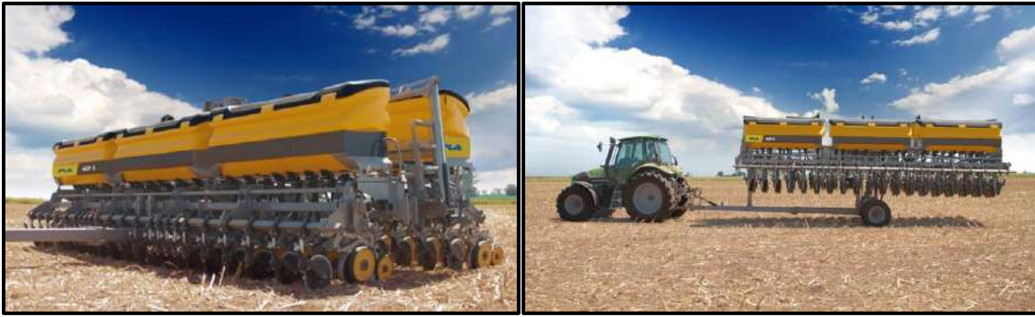
Figura I-2: Autotrailer – Posición en siembra y posición de transporte
