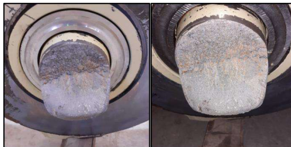
Figura 1-17: Falla de Perno dada en Transporte - (INTI, 2020)
