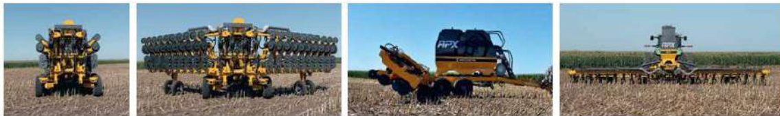
Figura I-3: AirDrill – Secuencia de plegado
