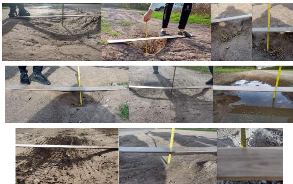
Figura 3-3: Mediciones de defectos en caminos rurales
