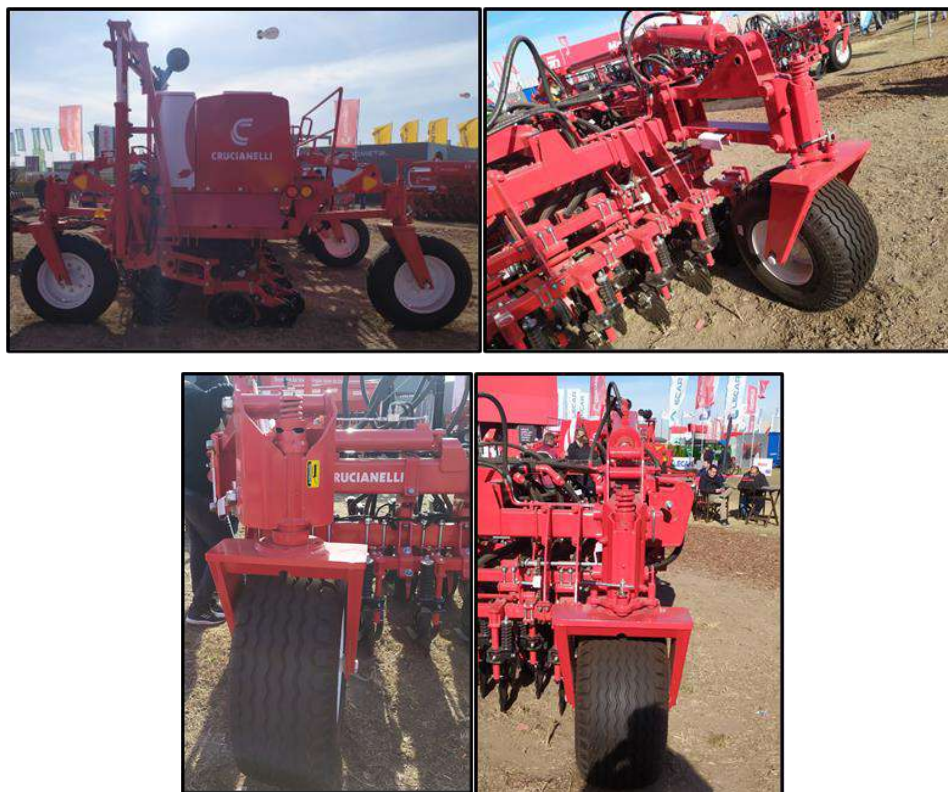
Figura 1-12: Sistema de traslado Sembradoras CRUCIANELLI - (AgroActiva 2022)
