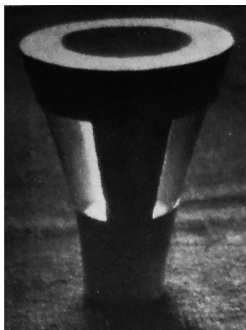
Amancio Williams. Modelo de prueba de la pieza de unión entre la columna y la bóveda cáscara, resultado final que nunca fue aplicado. nueva visión núm. 5 (1954) p. 34
