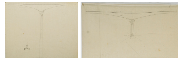
Estudios de acople en tres brazos de apoyo y a la vez conductos de desagüe. Fuente: AAW.
