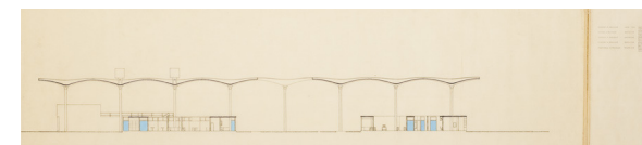
Corte mostrando la configuración que adquieren los hospitales con la cubierta desarrollada con las "bóvedas cáscara" diseñadas por Amancio Williams. Fuente: AAW.
