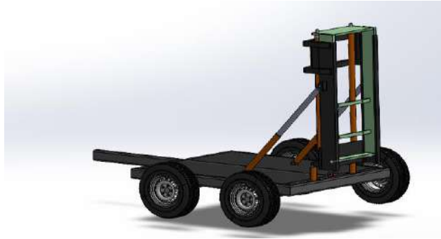
Figura 3-14: solución 6 actuadores retraídos.
