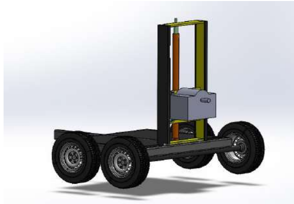
Figura 3-7: solución 3 actuador retraído.
