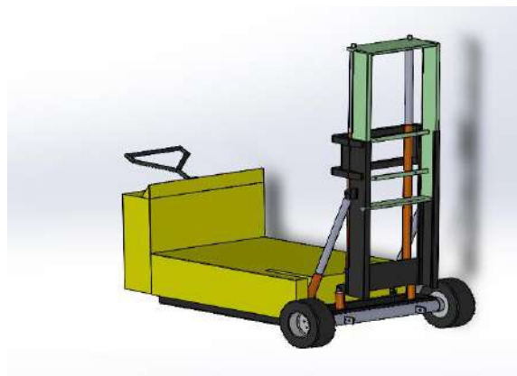
Figura 3-12: solución 5 actuadores extendidos.
