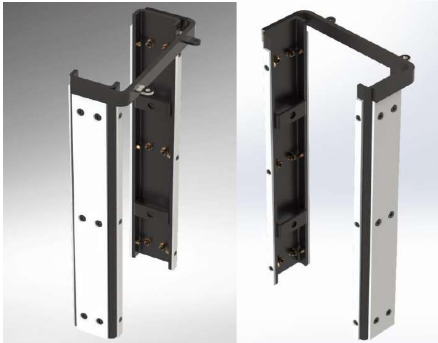
Figura 4-44: Diseño final torre interna.
