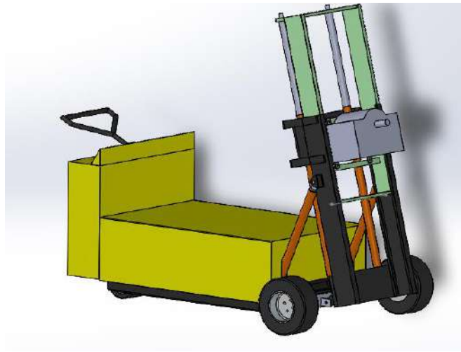
Figura 3-3: Solución 1 inclinación de torre.
