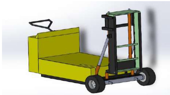
Figura 3-11: solución 5 actuadores retraídos.
