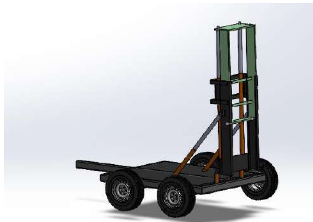
Figura 3-15: solución 6 actuadores extendidos.
