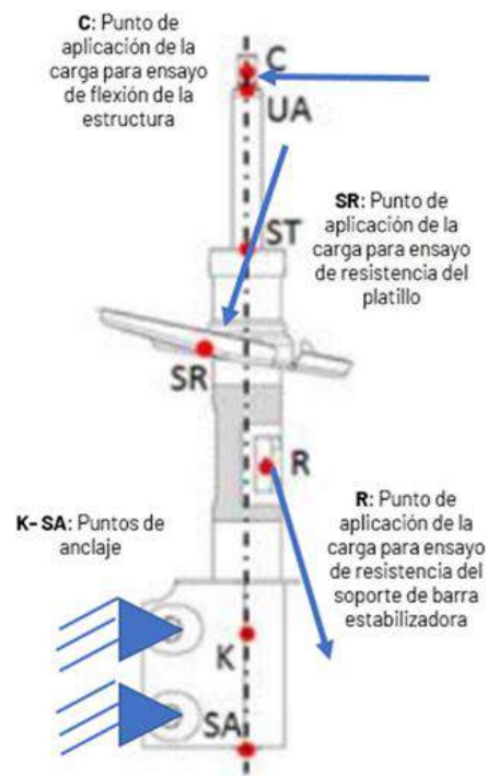
Figura 22: Puntos de control en donde se midieron las cargas en ensayo dinámico de vehículo.
