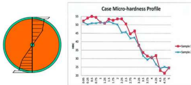
Figura 35: Esquematzacion de un modelo de material con endurecimiento superficial y valores de microdureza empíricos.
