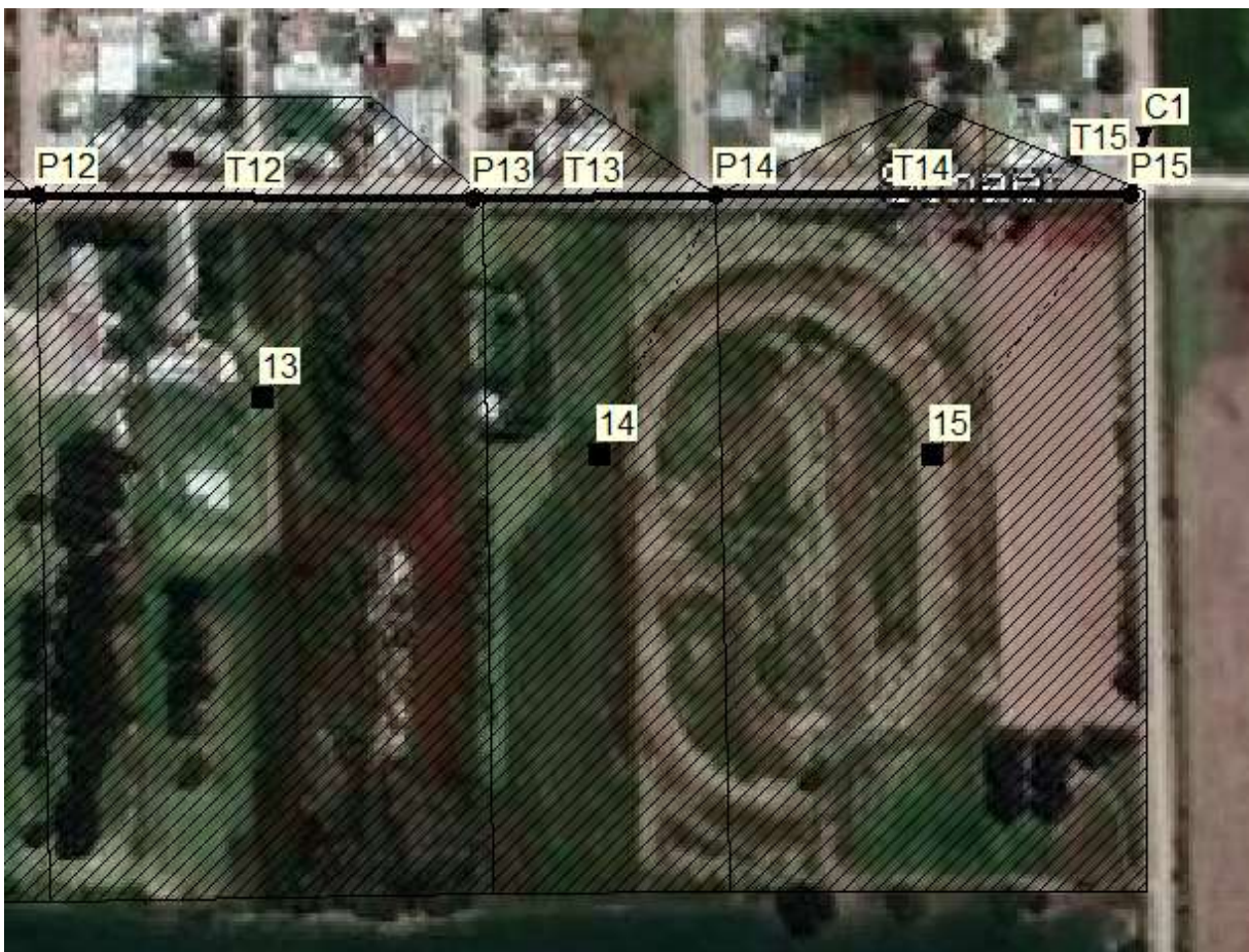
Figura 6 Detalle de elementos en salida de la cuenca - modelo SWMM
