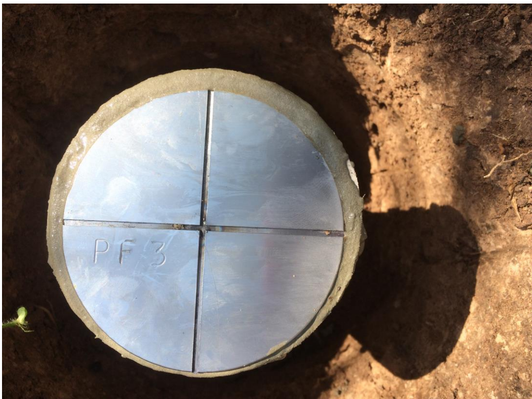
Figura 45: Resultado final del amojonamiento del punto fijo Nº 3
