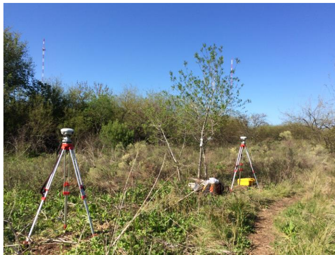
Figura 46: Receptores GPS sobre los puntos fijos 1 y 2
