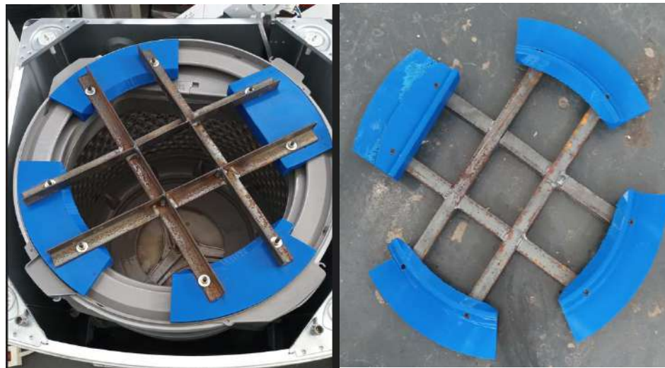
Figura 49 Dispositivo centrado de montaje.
