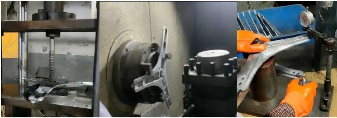
Figura 31 Brochado de la estrella, mecanizado y medidor de planitud con comparador
