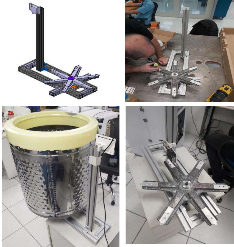
Figura 36 : Mediciones de excentricidad en laboratorio.
