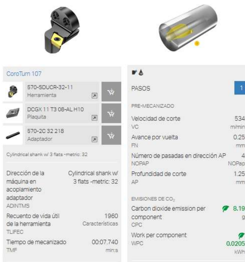
Figura 67 Datos de la herramienta y velocidad de corte.
