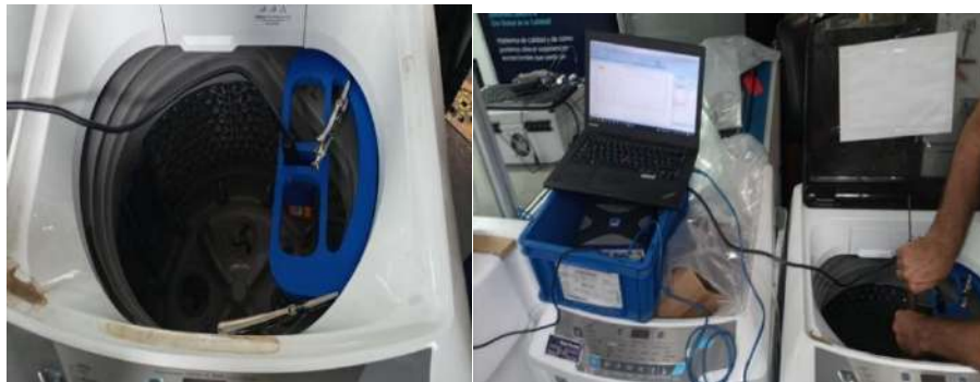
Figura 16 Mediciones de excentricidad
