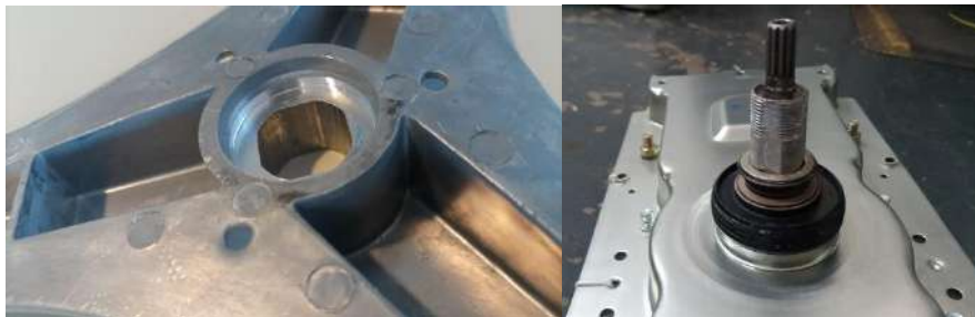
Figura 26 Eje sobre saliendo de la caja de engranajes y cara mecanizada de la estrella.
