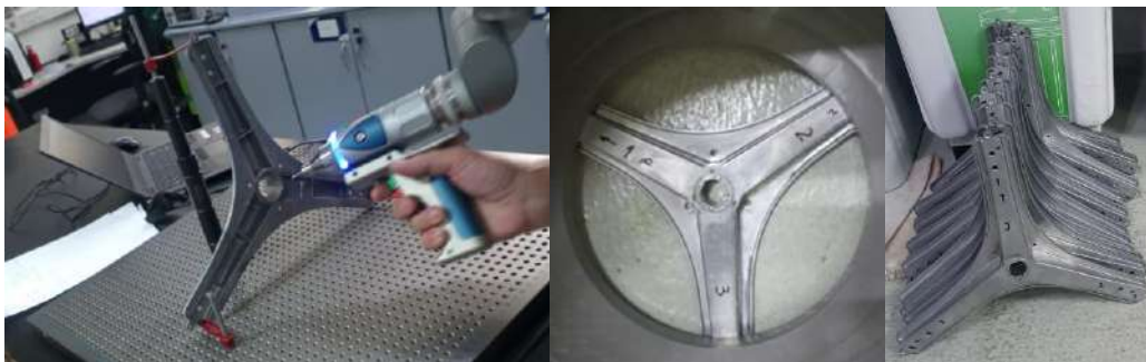
Figura 32 Mediciones de la perpendicularidad
