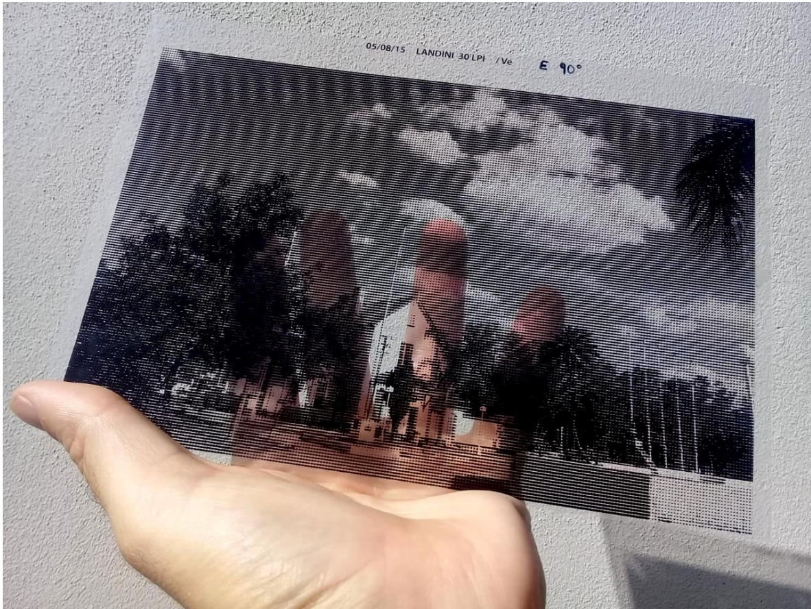
FIG 4: Imagen de un fotolito realizado a partir de filmación (película gráfica) con trama de semitono, donde se observa su translucidez y su opacidad.
