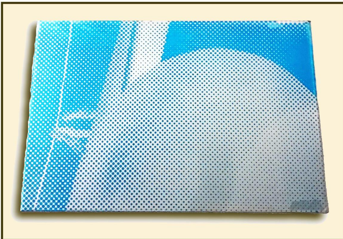
FIG 29: Chapa de aluminio, correspondiente a la prueba V, post insolado y revelado, con emulsión adherida en zonas de insolación.
