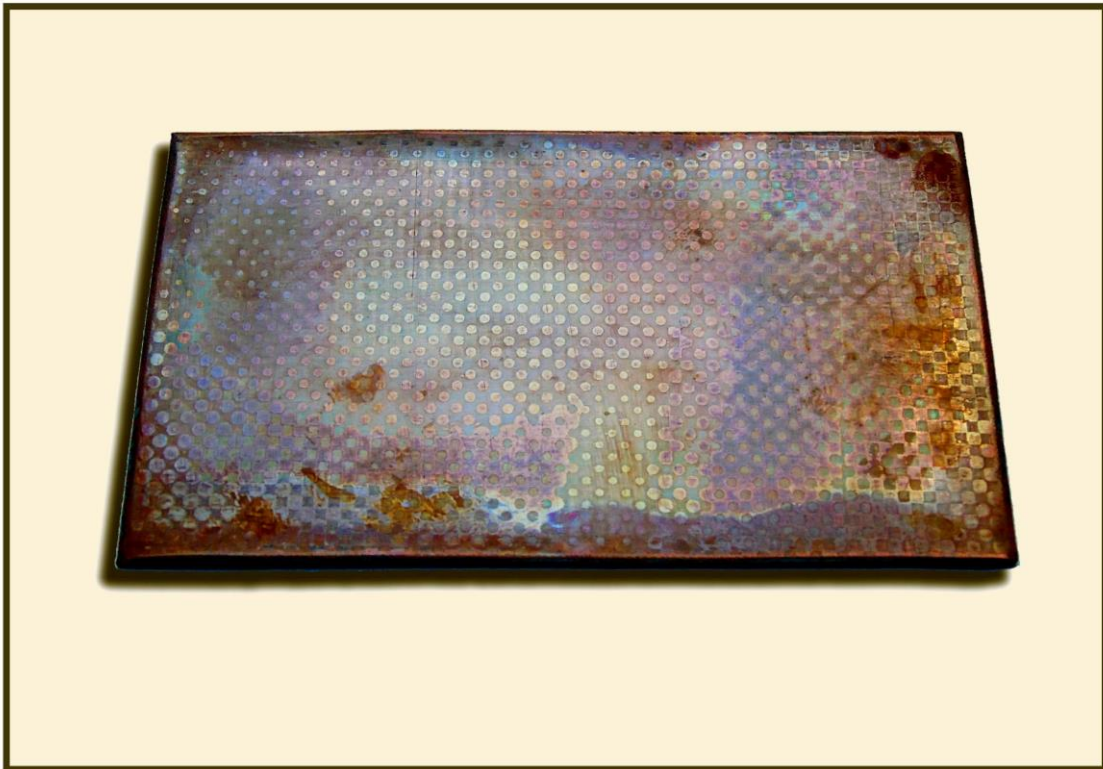
FIG 34: Chapa de Cobre con leve trama de semitonos grabada.
