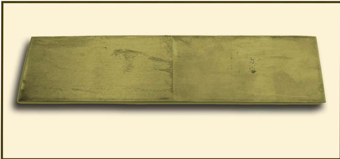
FIG 14: Placa de bronce correspondiente a la prueba II tratada con lija nº 360 expuesta a la luz durante 18 minutos.
