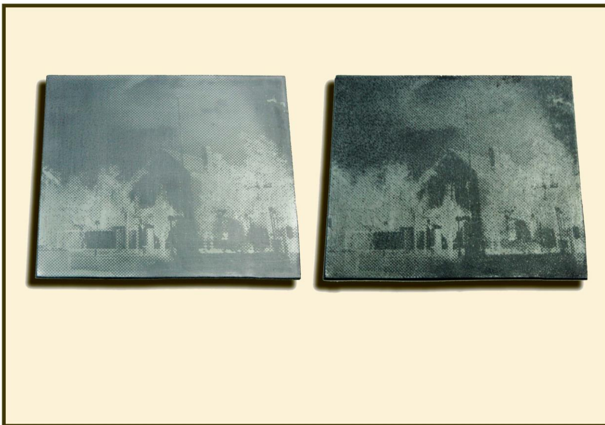
FIG 24: A la izquierda se observa la chapa de aluminio emulsionada y a la derecha la chapa de aluminio después del mordiente correspondiente a la prueba VI.
