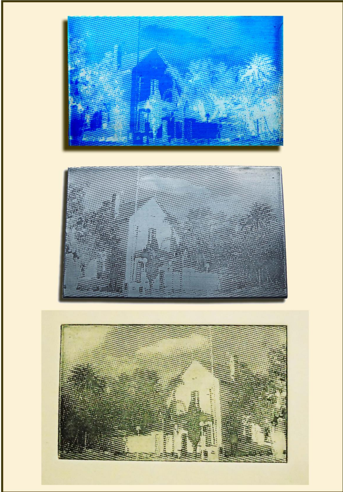
FIG 32: De arriba hacia abajo, chapa con emulsión adherida después del lavado, chapa de zinc grabada por sulfato de cobre y estampa de prueba.
