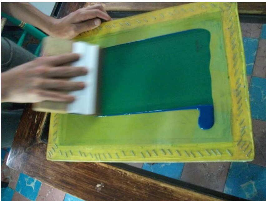
FIG 3: En la imagen se puede observar cómo se aplica la emulsión en un shablón para serigrafía y tener una noción de cómo es la consistencia de este producto.
