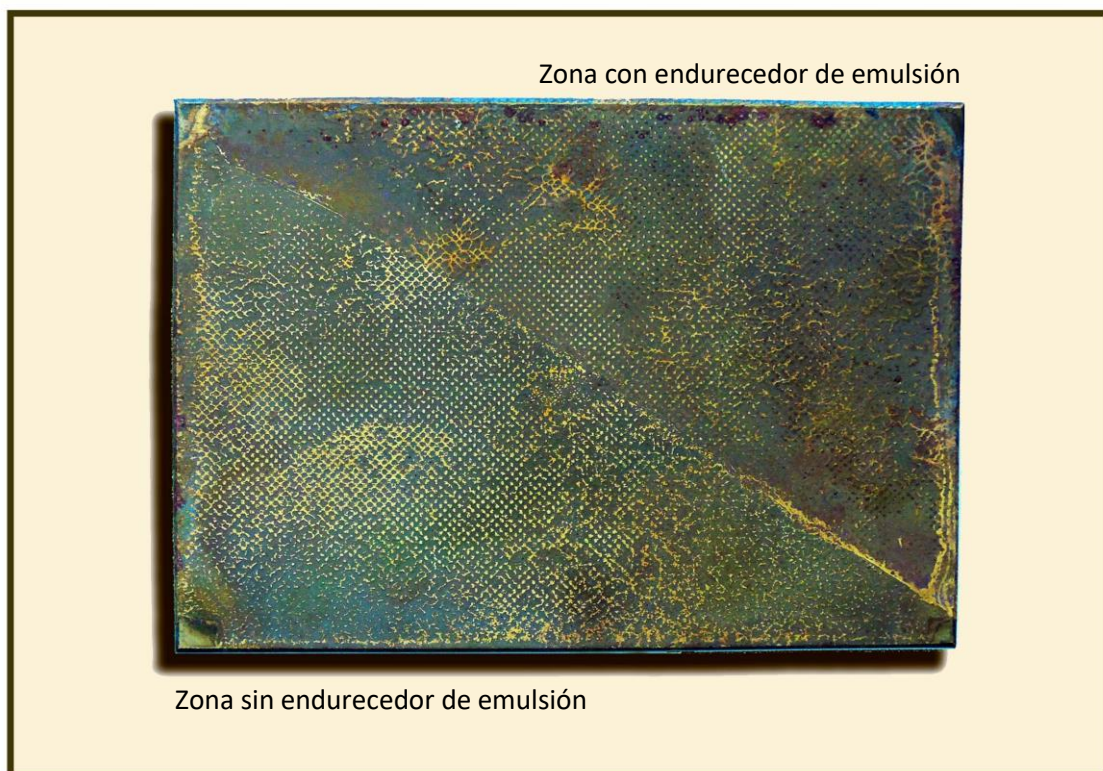
FIG 23: Imagen correspondiente a la prueba V, donde se observa la chapa dividida en dos zonas, arriba a la derecha la zona con endurecedor de emulsión y abajo a la izquierda la zona sin endurecedor de emulsión.
