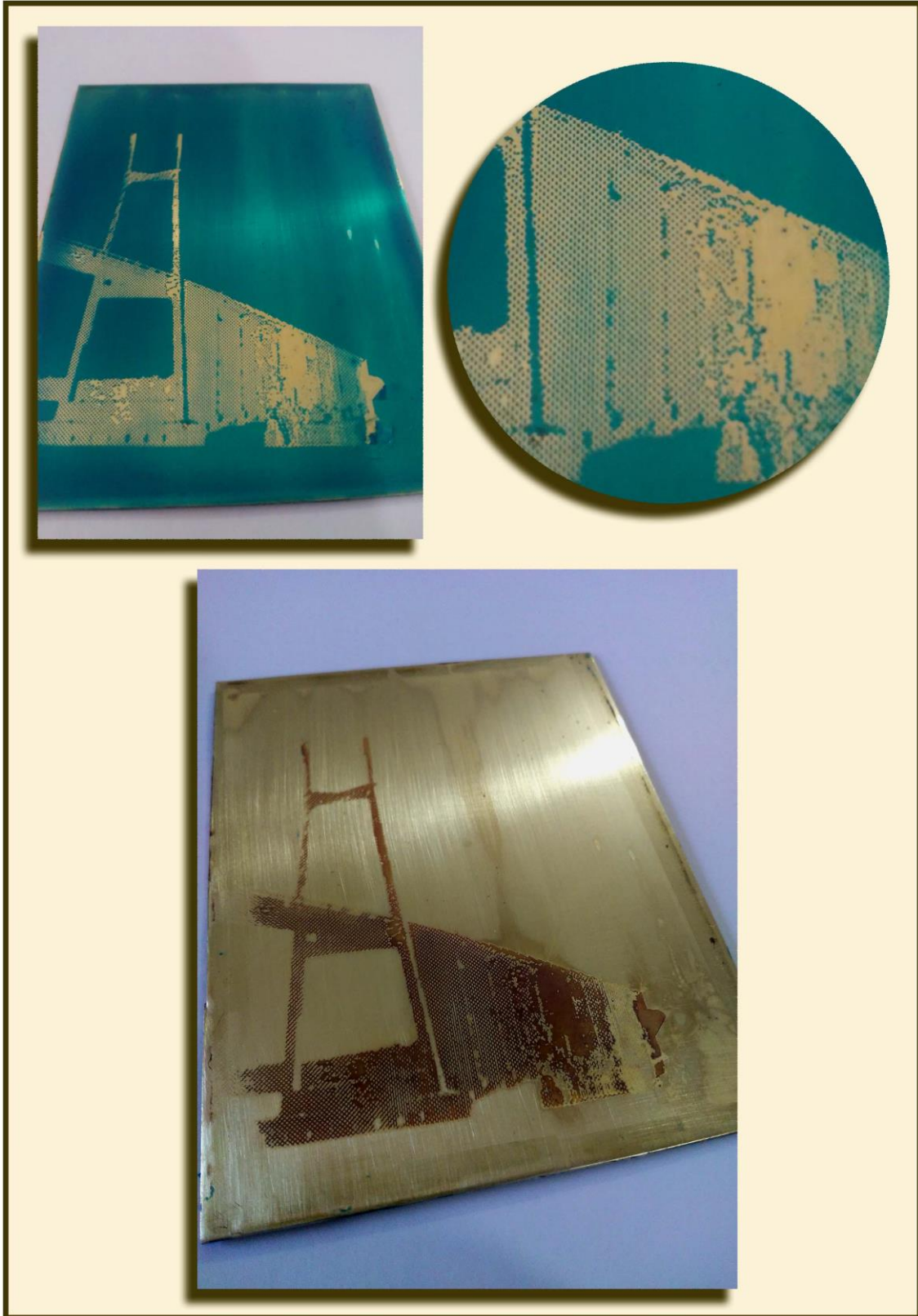
FIG 27: Arriba se observa la chapa emulsionada post lavado y un detalle de la trama. Abajo la chapa después de la mordida con percloruro de hierro.
