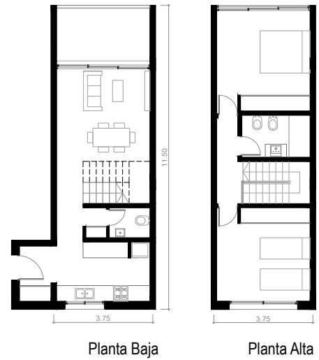
TIPOLOGÍA 16 Vivienda en dúplex de 2 dormitorios Superficie cubierta 85 m 2 Superficie exterior 8 m 2
