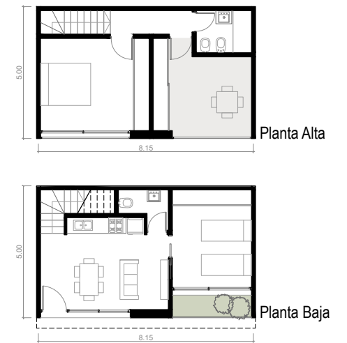
TIPOLOGÍA 28 - OPCIÓN C Vivienda de 2 dormitorios Superficie cubierta 71 m 2 Superficie exterior 12 m 2
