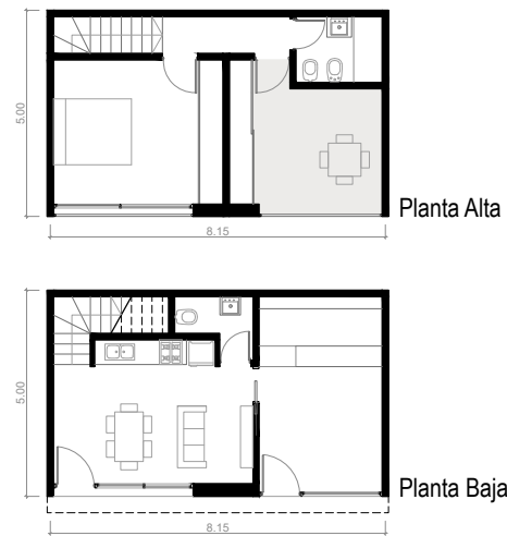
TIPOLOGÍA 28 - OPCIÓN B Vivienda de 1 dormitorio Superficie cubierta 73 m 2 Superficie exterior 10 m 2
