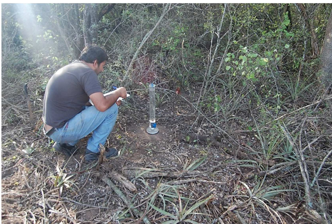
Determinación de infiltración en tratamiento de bosque.
