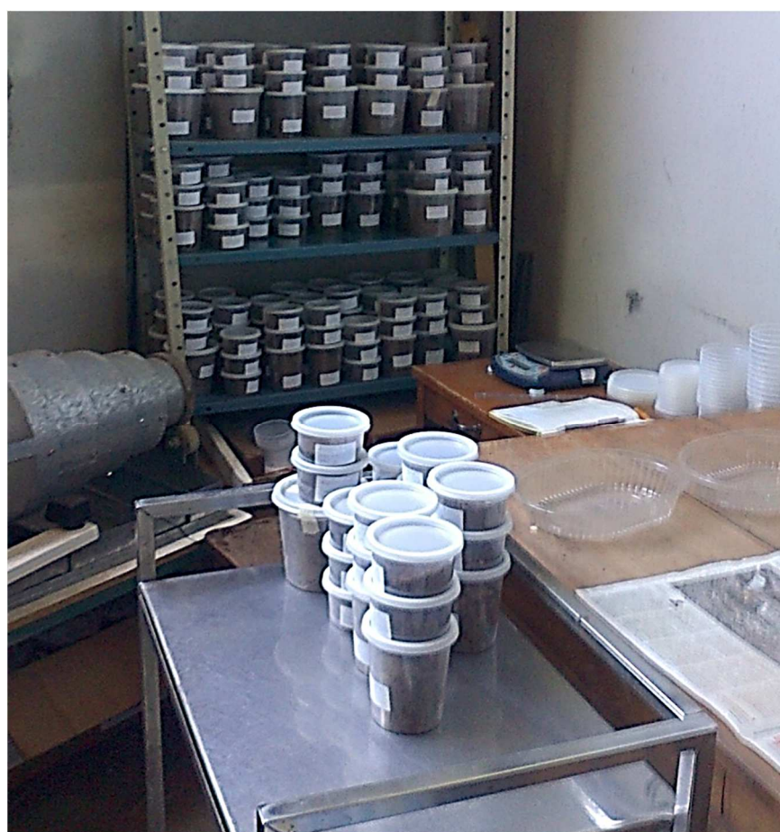
Muestras separadas por tamizado en seco.
