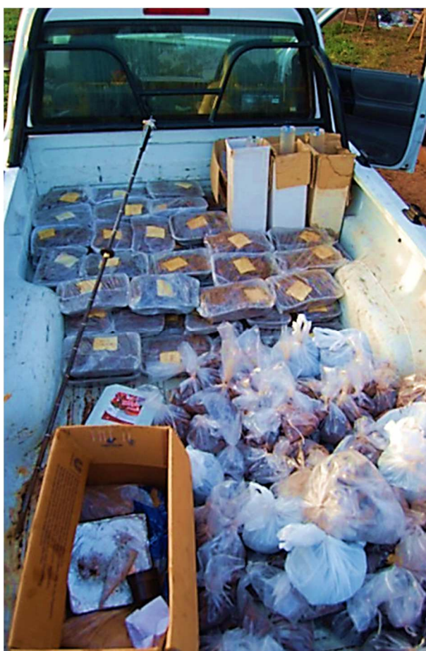
Retorno del muestreo diario hacia el laboratorio: Infiltrómetros, penetrómetro, muestras para determinaciones químicas y estabilidad estructural.
