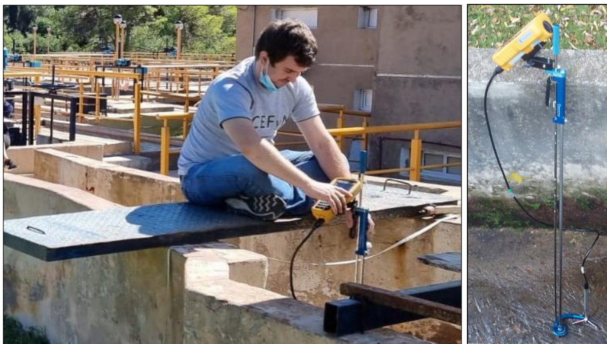
Figura 4. Estimación de caudal por velocimetría acústica Doppler. En la imagen izquierda se muestra el sitio de medición. En la imagen derecha se muestra un detalle del instrumento de medición.
