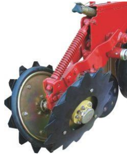
Figura 1-21: Ruedas con cubiertas de goma presión cero [7]
