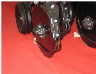
Figura 1-19: Ruedas con llantas rígidas abiertas en el plano medio [7]
