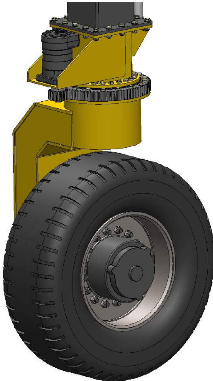
Figura 26: Sistema de tracción: wheel drive comercial Bonfiglioli Serie 600
