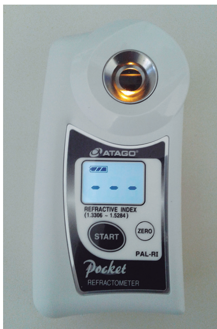
Figura 7. Imagen del refractómetro digital Atago PAL-RI para determinación de índices de refracción en un rango de valores de 1.3306 a 1.5284. En el visor puede observarse el nivel de carga de baterías
