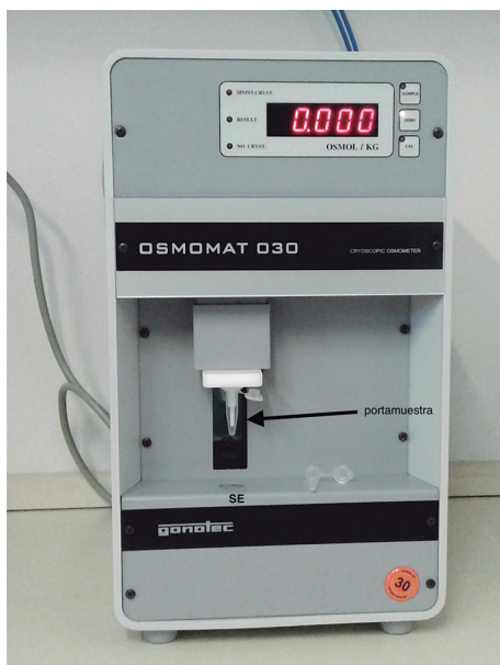
Figura 13. Osmómetro Osmomat 030, se puede observar el tubo conteniendo la muestra insertado en el portamuestras que contiene el termistor que monitorea la temperatura del proceso de enfriamiento. Para activar la medición, el porta muestras se inserta en el sistema de enfriamiento (SE) mediante un aditamento dispuesto a tal fin.
