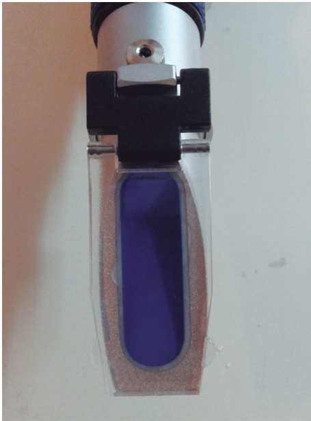
Figura 5B. distribución uniforme de la muestra sobre el prisma
