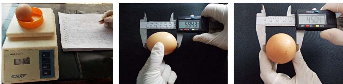
Figura 3 - Registro del peso del huevo (izquierda) con balanza de precisión y de la longitud (centro) y la anchura (derecha), con calibre micrométrico (Fuente: Sabina Advínculo)
