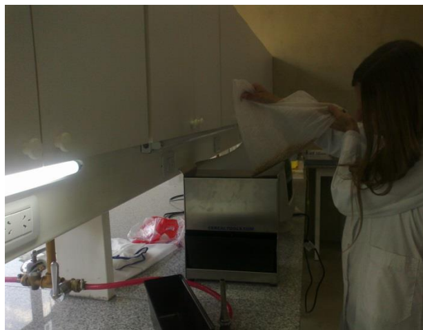
Fig. 3: Realización de la operación de homogenizado y división de las muestras con el Divisor Rifle.
